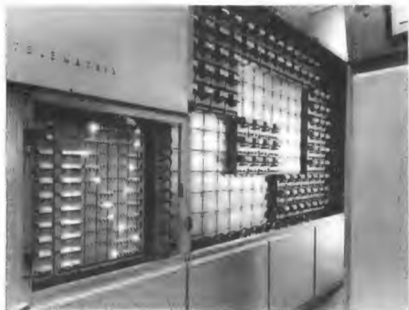
Bild 5. Neuer fernbedienbarer Antennenwahlschalter vom Typ Telematrix mit elf Sendereingängen und fünfzehn Antennenausgängen. Links zusätzliches Feld für Handbedienung
