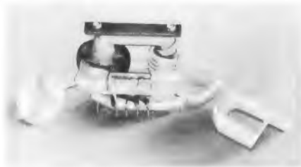
Bild 2. Steckbarer Zeilentransformator mit Fassung (SEL), der von einigen Firmen zur Service-Erleichterung eingebaut wird
