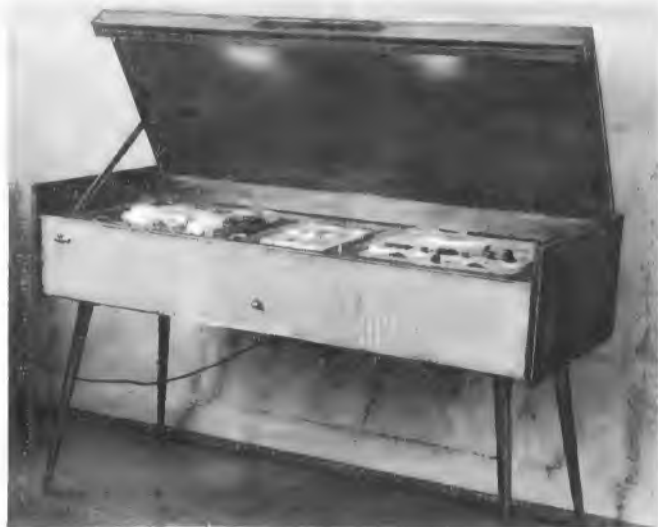
Bild 1. Ansicht der selbstgebauten Truhe für zwei Tonbandgeräte, ein Mischpult und verschiedene Zusatzeinrichtungen. Die Koffergeräte sind nicht fest eingebaut, so daß sie auch für Außenaufnahmen zu verwenden sind. (Will man die Truhe auch frei im Raum verwenden, um das Mikrophon in Blickrichtung zu haben, dann empfiehlt es sich, den Deckel abnehmbar zu machen)
