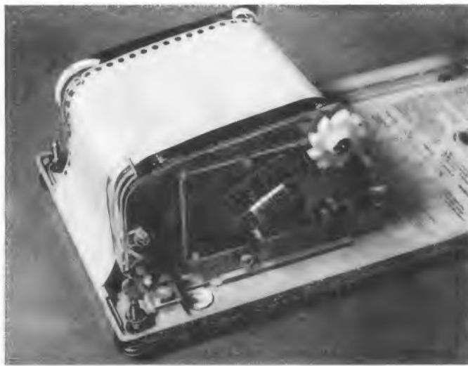
Bild 3. Das Antriebswerk des Multiscript 3; das weiße Zackenrad rechts betätigt den Fallbügel, der den Zeiger auf das Registrierpapier drückt. Schräg links unter dem Zackenrad befindet sich das leicht zu betätigende Umschaltgetriebe für drei Papiergeschwindigkeiten. Durch Auswechseln von Zahnrädern können andere Geschwindigkeiten vorgesehen werden
