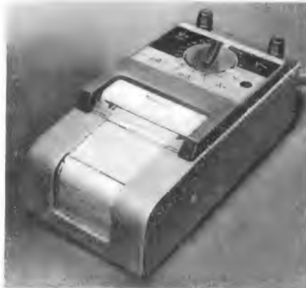
Bild 1. Ansicht des Multiscript 3; vorn ist der Registrierstreifen zu sehen, auf dem in bestimmten Abständen nochmals sämtliche Meßbereiche aufgeführt sind
