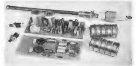
Bild 1. Die Einzelteile des Dreikanal-Senders einschließlich Deac-Batterie und Teleskop-Antenne
