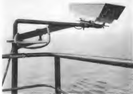
Oben: Bild 4. Diese Kompakt-Kamera kann wahlweise an der Back- oder Steuerbordseite des Vorschiffes montiert werden. Die Kameras sind gegen rauhen See-gang besonders ge-schützt durchgebildet
