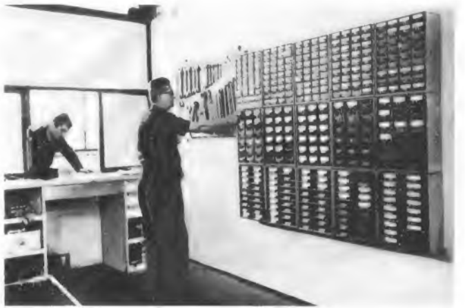
Die Magazine lassen sich nach Wunsch mit verschieden großen, durchsichtigen Kunststoff-Schublen bestücken
