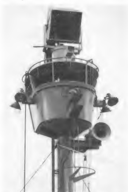
Bild 3. Ausguckmast auf dem Vorschiff. Ganz oben ist der zur Zeit nicht benutzte Infrarot-Scheinwerfer montiert, darunter die Philips-Kompakt-Kamera
