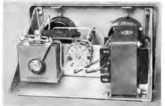
Bild 12. Blick auf das Chassis von hinten; links der Gleichrichter
