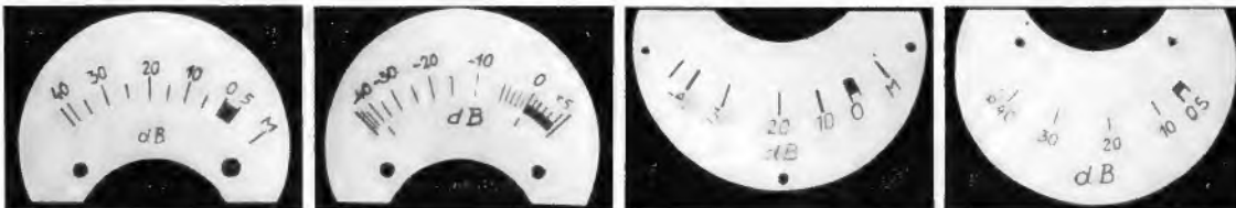
Bild 4. Verschiedene bei den Versuchen entstandene provisorische Skalen; M = mechanischer Nullpunkt
