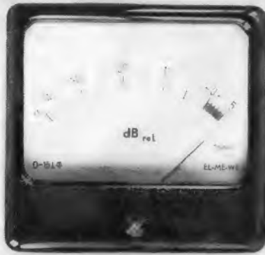
Bild 5. Meßinstrument mit Spezialskala für den Aussteuerungsmesser U 702 nach der Schaltung Bild 2 (Seite 147)
