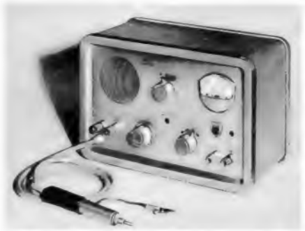
Bild 1. Ansicht des Signalverfolgers GM 7600 mit dem Tastkopf
