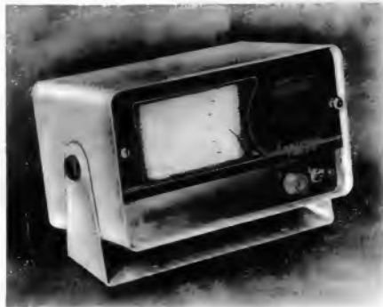
Bild 5. Schreibendes Echolot mit zwei Bereichen 0...120 Fuß und 120...240 Fuß. Frequenz: 227 kHz, Impulsfrequenz 300/Minute; für 6- oder 12-V-Betrieb (Modell DE-705 A von Raytheon)
