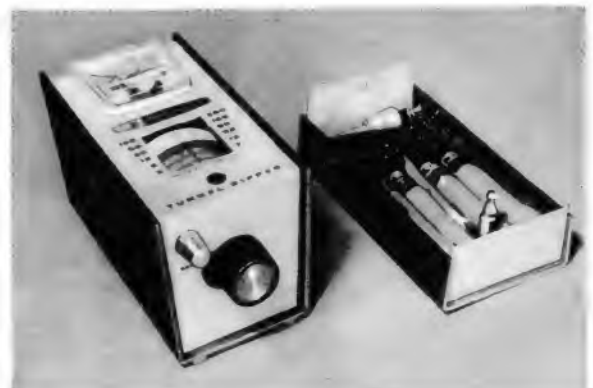
Bild 4. Der Tunnel-Dipper mit abgenommener Gehäusekappe. Die Steckspulen sind in Schaumgummi gebettet im Deckel untergebracht (rechts). Das Schaumgumpolster verhindert außerdem ein Beschädigen oder Zerkratzen des Instrumentes
