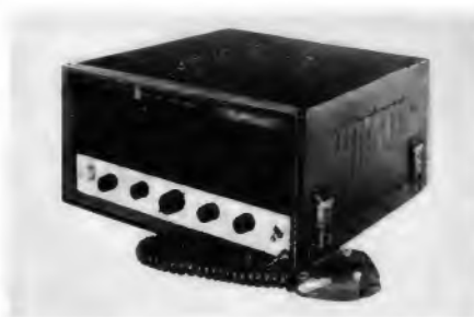
Bild 10. Amerikanisches Radiotelefon für Bordbetrieb mit 45 W Ausgangsleistung, acht Quarfrequenzen zwischen 2 und 10 MHz und getrenntem Stromversorgungsteil (Modell AE-65 von Alpeco)
