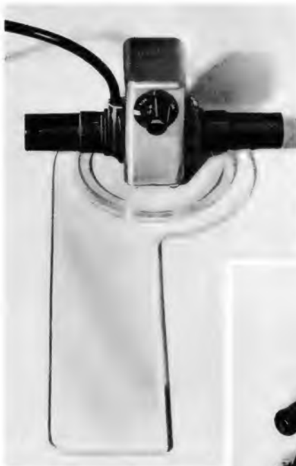
Bild 17. Ferrit-Navigateur, ein Peil-zusatz für den Sailor 16 T
