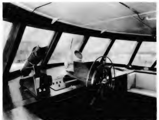
Bild 19. Links im Bild Beobachtungsgerät des kleinen Radargerätes Consort von Marconi im Ruderhaus einer Jacht. Zwei solide Handgriffe erlauben Festhalten bei Seegang
