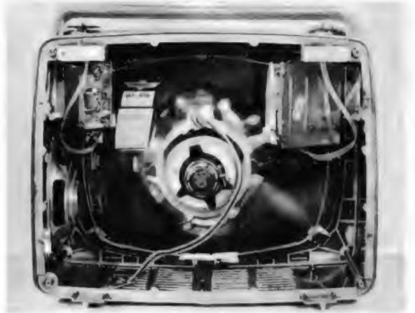
Bild 1. Rückseite des Gehäuses ohne Chassis; links oben der VHF-Kanalwähler, rechts oben der UHF-Tuner
