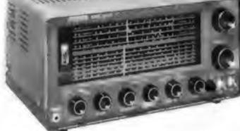
Ein hochwertiger Allwellen-9-Kreis-Empfänger von kommerziellem Aussehen und mit folgenden Eigenschaften: Hohe Empfindlichkeit, S-Meter, Störbegrenzer, veränderliche Bandbreite, Telegrafie-Überlagerer, Sende-Empfangsschalter, Kopfhörer- und Lautsprecher-Anschluß.
