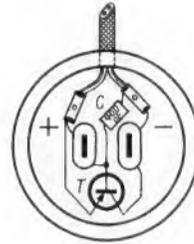
Bild 1. So werden der Transistor T und der Kondensator C in die Hörerkapsel eingebaut und angeschlossen
