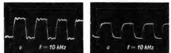
Bild 9. Impulsbilder am Ausgang des Verstärkers NF 1 bei verschiedenen Impulsfolgefrequenzen
