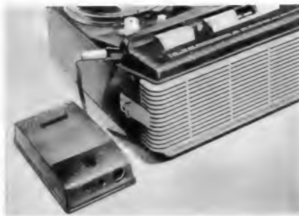
Bild 1. So wird der Transistor-Zusatzverstärker an die Philips-Tonbandgeräte RK 14 und RK 30 angesteckt
