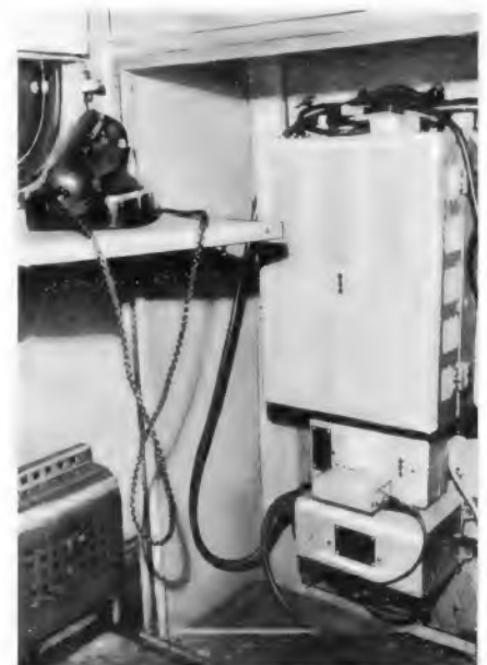
Bild 3. Die gesamte von der Firma Tekade gebaute Sprechfunk-Anlage B 72 läßt sich in einem kleinen Schränkchen unterbringen
