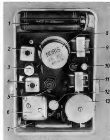
Bild 3. Montagesseite der gedruckten Schaltung; 1 = 9-V-Batterie, 2 = zweites Zf-Filter, 3 = Zf-Transistor, 4 = erstes Zf-Filter, 5 = Oszillator-spule, 6 = Abstimm-Drehkondensator, 7 = Ferritantenne, 8 = Lautsprecher, 9 = Ferrit-Übertrager, 10 = Nf-Transistor, 11 = Treiber-Transformator, 12 = Hf-Transistor, 13 = Lautstärke-Potentiometer
