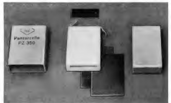
Bild 2. Die Bestandteile der Panzerzelle; in der Mitte die eigentliche Rulagzelle, rechts die innere Panzerhülse, ihre Stirnflächen dienen später als positiver Anschlußpol; links die äußere Panzerhülse = negativer Anschlußpol
