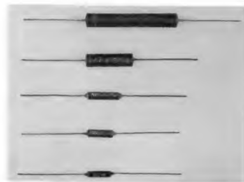
Bild 3. Metall-Schichtwiderstände. Diese Widerstände für 0,1 W bis 2 W Belastbarkeit sind lackiert und haben axialen Drahtanschluß (Bauform MLAD von Dralowid). Sie werden in den Gruppen TK 100 ( \text{TK} \leq \pm 100 \cdot 10^{-6}/^{\circ}\text{C} ) und TK 50 ( \text{TK} \leq \pm 50 \cdot 10^{-6}/^{\circ}\text{C} ) geliefert
