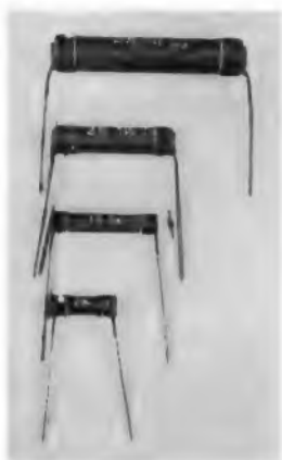
Bild 1. Kohle-Schichtwiderstände 0,5 DIN 41 400. Diese Widerstände für 0,25 W bis 2 W Nennbelastbarkeit entsprechen den Normen DIN 41 401 bis 41 404
