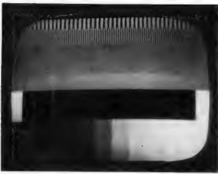
Bild 4. Bildhöhe und -Linearität sind mangelhaft, weil die Anodenspannung des Sperrschwingers zu gering ist
