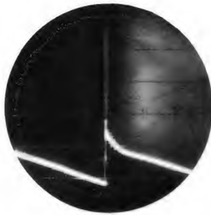
Bild 15. Derselbe Impuls aus Bild 13, die Rücklauflinien sind nicht zu trennen und zeigen dazu noch Einschwingen infolge eines Windungsschlusses auf der Sekundärseite des Bildkipp-Ausgangstransformators
