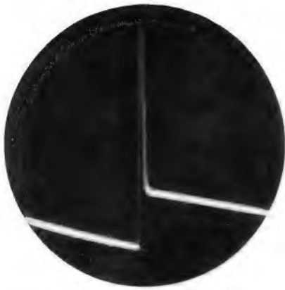
Bild 14. Richtiger, aber stark gedehnter Impuls an der Anode der Endröhre. Die Rücklauflinien sind deutlich getrennt
