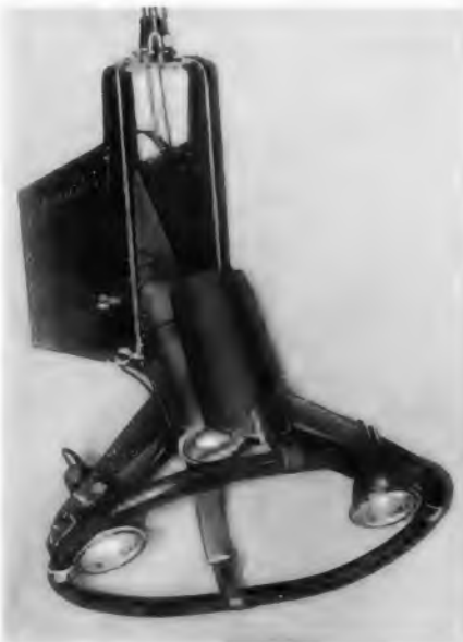
Bild 1. Unterwasser-Fernsehkamera Ingatlas 50 c + d für Wassertiefen bis zu 2000 m mit zwei 500-W-Scheinwerfern
