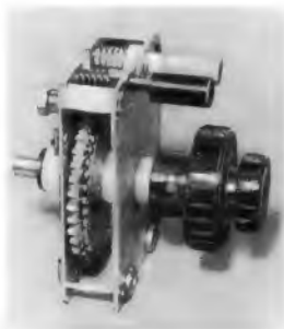
Bild 1. Ansicht des Mentor-UHF-Rastenschalters; rechts oben die beiden Tasten zum Einrasten und Entrasten (Löschen)
