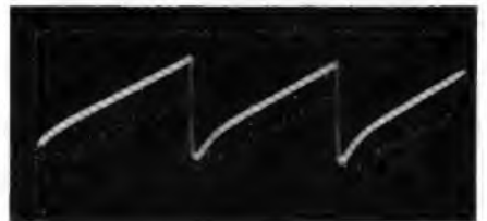
Bild 13. Fehlerhafter Impuls am Steuergitter durch Rückwirkung des Windungsschlusses in der Ablenkspule auf die Gegenkopplung
