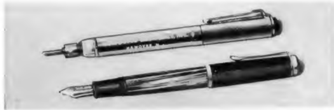
Bild 1. Der Mosquito-Signalgeber (oben) im Größenvergleich zu einem Füllhalter. Im Oberteil des Mosquito befinden sich die 1,5-V-Stabzelle und eine Telefonbuchse für die Erdverbindung bei niederohmigen Meßobjekten
