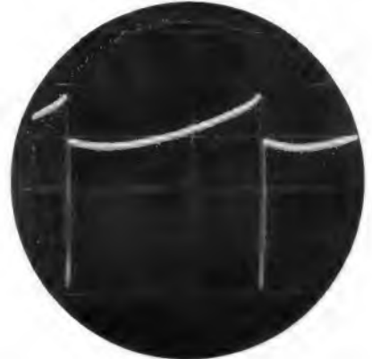
Bild 12. Richtiger Gitter-Steuerimpuls mit parabel-förmigem Anstieg
