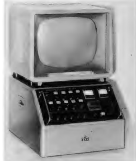
Bild 2. 43-cm-Sichtgerät mit Bedienungsplatte für Fernseh- und Fotokamera-Fernsteuerung
