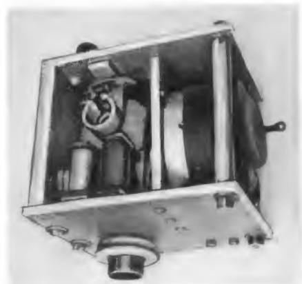
Bild 19. Gesamtansicht von der Relaisseite. Der Antrieb wird durch eine sauber rechtwinklig gebogene Haube abgedeckt
