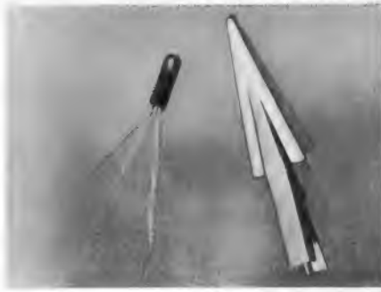
Bild 3. Wärmeableitklemme der Firma Ruhstrat zum Ableiten der Wärme beim Einlöten von Halbleiter-Bauelementen
