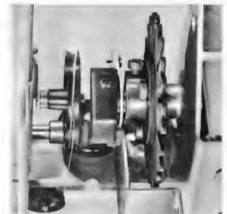
Bild 3. Malteserkreuzschaltung am VHF-Kanalwähler
