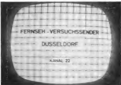
Testbild mit Stationsangabe des Fernsehversuchsenders Düsseldorf, aufgenommen mit einer Einbauantenne in etwa 8 km Entfernung vom Sender
