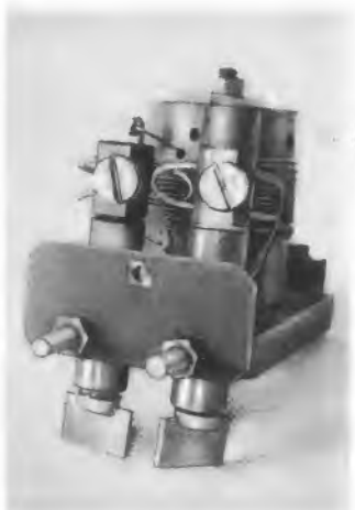
Bild 35. Ein selbstgebauter Normalwiderstand
