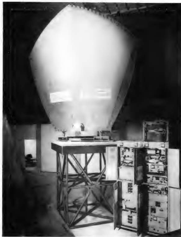
Die Telefunken-Muschelantenne für 960 Ferngespräche
