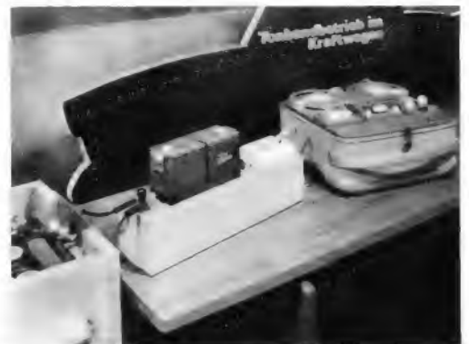
Rechts: Bild 8a. Gleichstromzerhacker zum Speisen eines Tonbandgerätes aus der Autobatterie (fuba)
