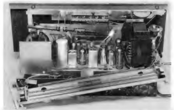
Chassis des Tischempfängers Philips Capella-Reverbeo (B 7 X 14 A) mit abgeschraubter Nachhall-Einrichtung. Sie hat bequem im Tischgehäuse Platz
