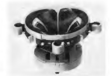
Bild 2. Ablenssystem AS 110-3 mit Zentrier magnet und Polschuhen zur Kissen- und Trapezverzerrung
