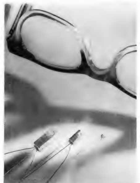
Bild 1. Neue Telefunken-Nf-Transistoren, von links nach rechts: ein Treibertransistor AC 118, ein Vorstufentransistor AC 122 und ein Kleinsttransistor für Hörbrillenschaltungen, darüber zum Vergleich ein Teil einer Brille
