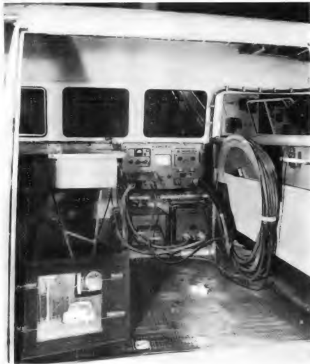
Links: Warnung an alle Kraftfahrer: Dieser Wagen mit Polizei-Verkehrsradar mißt die Geschwindigkeit der Kraftwagen und fotografiert mit einem Foto-Blitzgerät das Kennzeichen
