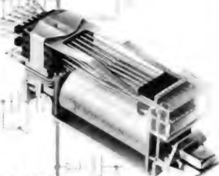
FLACHRELAIS MIT DRAHT-FEDERSATZ
