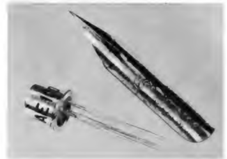
Bild 2. Tunneliode AE 100 von Telefunken im Größenvergleich zu einer Schreibfeder
