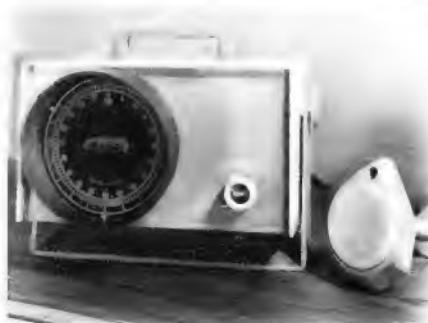
Heathkit-Echolot für Sportjachten; auf der kreisförmigen Skala wird durch Lichtmarken die Wassertiefe in Fuß angezeigt
