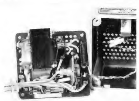
Das Ladegerät für Dryfit-Batterien von Sonnenschein arbeitet mit elektronischer Spannungsabschaltung
