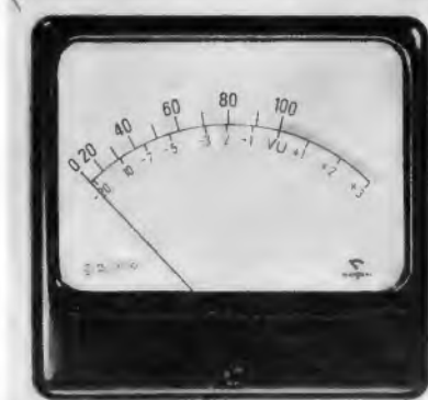
Bild 12. Frontplatte des VU-Meters für die Aussteuerungsanzeige in Tonfrequenzanlagen (Gossen)
