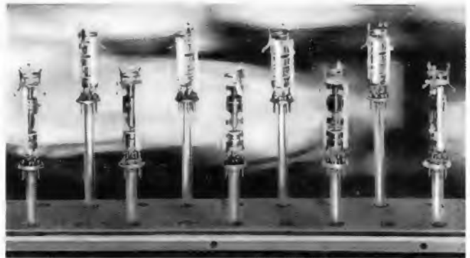
Die sogenannten Elektronen-Kanonen, wichtige Bestandteile der Fernseh-Bildröhren (Telefunken)
