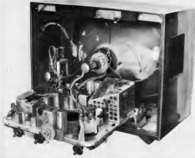
Bild 2. Rückseite des Gerätes mit herausgeklapptem Chassis
