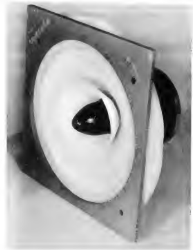
Bild 4. Allfrequenz-Lautsprecher mit 15 cm Durchmesser. Papierkonus mit Kunststoff-Aufhängung, Hochtonkegel aus Aluminium, Feldstärke im Spalt 17 500 Gauß, 6 W belastbar, Frequenzbereich 20...18 000 Hz, mit Ticonal-Magnet (Modell PM 6 von Lowther)
