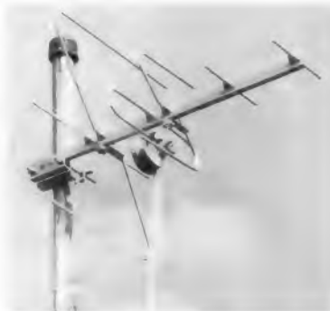
Bild 5. Kleine Breitband-UHF-Antenne (Dezi-Dura 8 von Kathrein)
