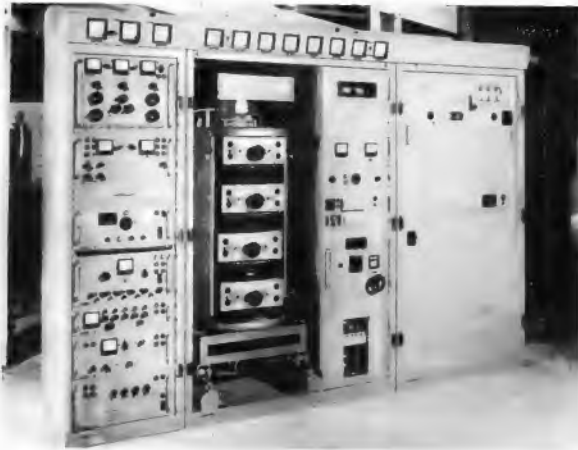
◀ Ein 10-kW-Fernsehsender für Bereich IV von Telefunken. Das offene Gestell enthält das Klystron
