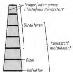
Bild 2. Aus einem Stück gepreßte UHF-Innenantenne; die Elemente sind metallisierter Kunststoff
