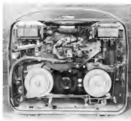
Bild 1. Blick in die Mechanik des Grundig-Tonbandgerätes TK 14
