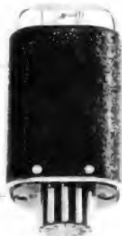
POLARISIERTES RELAIS (mit hermetisch abgeschlossenem Kontakt)
