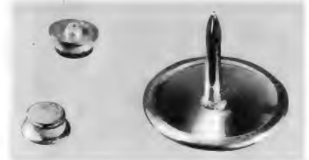
Bild 3. Die Koaxialdiode AE 101 im Größenvergleich zu einem Reißnagel
