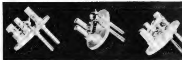
Bild 9. Aufsteckbare Filter und ein Dämpfungsglied (ohne Kappen). Links: UKW-Sperrfilter gemäß Bild 6, Mitte: Dämpfungsglied gemäß Bild 7, Rechts: Zf-Sperrfilter gemäß Bild 2
