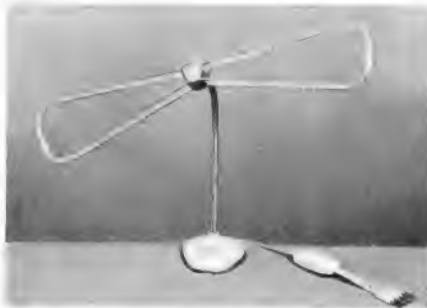
Bild 1. Bei der Zimmerantenne Zifa 34 von Hirschmann wird der Band-III-Dipol durch vorgesezte kurze Koppelstäbe auch für Bereich IV abgestimmt
