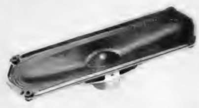
Bild 9. Oval-Lautsprecher, wie er im Magnetophon 96 verwendet wird
