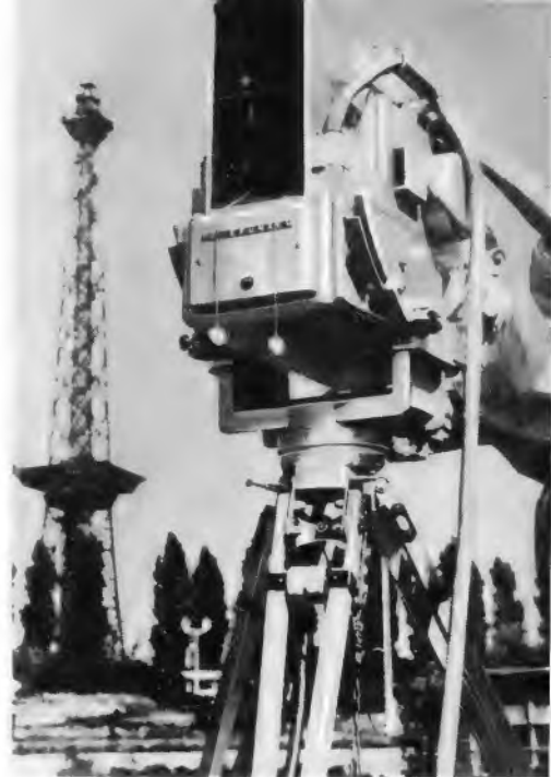
Telefunken-Superikonoskop-Kamera von Mechau, erbaut 1939 im Auftrage der Reichspost für die geplante Übertragung der XII. Olympischen Spiele aus Helsinki (1940)
