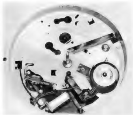
Bild 7. Die Schnellstop-Einrichtung unter dem Plattenteller des Musikus 105 V
