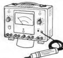
Röhrenvoltmeter GM 6009 20 Hz...100 MHz für U, I, R 22 Meßbereiche
