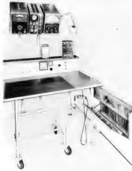
Bild 4. Die herausziehbare Werkzeuglade kann aufgeklappt werden und befindet sich in Griffnähe
