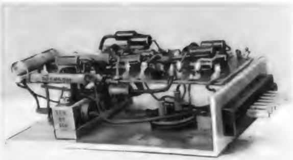
Bild 4. Der fertige Verstärker
