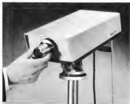
Bild 1. Compact-Fernseh-Kamera EL 8000 mit auswechselbaren Objektiven, bestückt mit 26 Transistoren und 10 Dioden
