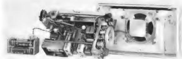
Links: Bild 7. Chassis mit Batteriehalterung (links) und Frontschale des Gehäuses mit Lautsprecher (rechts)
