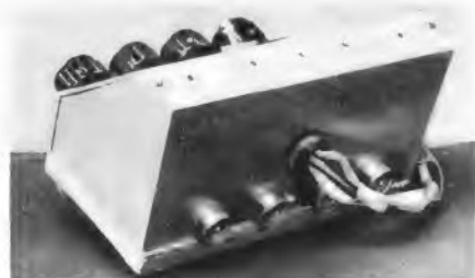
Bild 3. Rückansicht mit den Anschlußbuchsen für die Mikrofone und dem Kabel zum Verstärker
