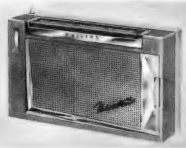
Bild 1. UKW-Taschensuper Philips-Nicolette L 2 D 12 T mit drei Wellenbereichen
