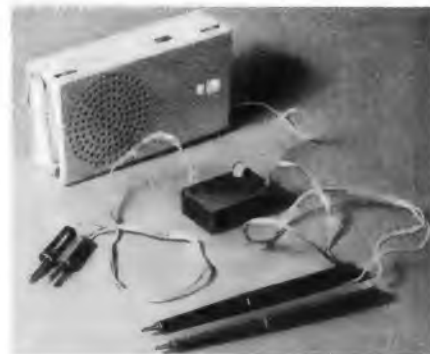
Bild 2. Mustergerät, an den Nf-Verstärker eines Taschensupers angeschlossen. Die beiden Banaanstecker sind für Antennen- und Erdschlusß vorgesehen
