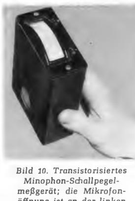
Bild 10. Transistorisiertes Minophon-Schallpegelmeßgerät; die Mikrofonöffnung ist an der linken Seitenwand zu erkennen
