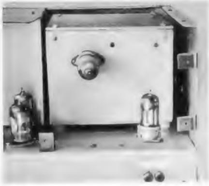
Links: Bild 1. Geanzerte Oszillatorstufe für einen Telegrafieempfänger
