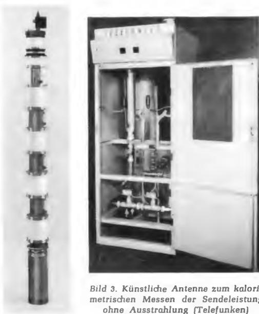
Bild 3. Künstliche Antenne zum kalorimetrischen Messen der Sendeleistung ohne Ausstrahlung (Telefunken)
