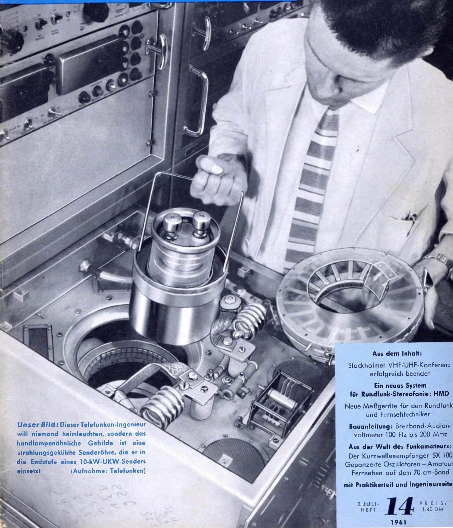
**Unser Bild:** Dieser Telefunken-Ingenieur will niemand heimleuchten, sondern das handlampenähnliche Gebilde ist eine strahlungsgekühlte Senderöhre, die er in die Endstufe eines 10-kW-UKW-Senders einsetzt (Aufnahme: Telefunken)
