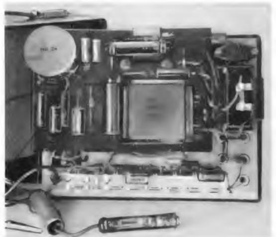
Unten: Bild 2. Die erweiterte Schaltung des Audion-Voltmeters M 583. Der Gleichrichter rechts unten, unterhalb von Rö 3, ist Gl 3
