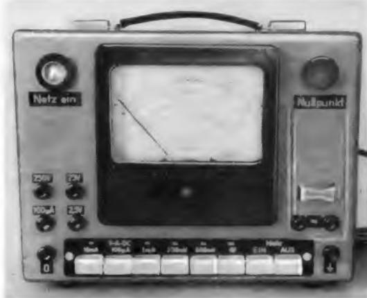
Bild 1. Ansicht des verbesserten Audion-Voltmeters M 583
