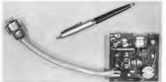
Röhrenbestückung und dem erforderlichen Aufwand an Bauteilen vermitteln die Bilder 12, 13 und 14. Einfache Befestigung an der Rückwand mittels Kordelschraube und elektrische Verbindung über 9polige Steckkupplung erleichtern besonders die nachträgliche Ausrüstung der Empfänger.
