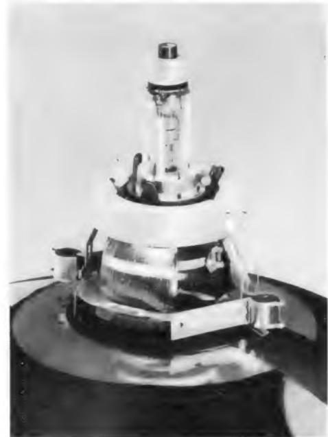
Bild 9c. Ablenkspulensatz auf dem Hals einer Bildröhre
