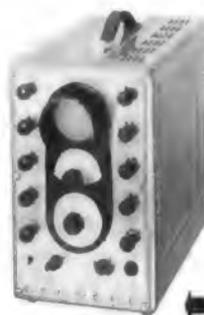
Das transportable Fernseh-Servicegerät enthält Wobbler und Frequenzmarker, Breitbandoszillograph, Bildmuster-generator und VHF-UHF-Prüfgenerator
