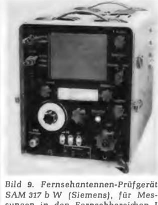
Bild 9. Fernsehantennen-Prüfgerät SAM 317 b W (Siemens), für Messungen in den Fernsehbereichen I bis V geeignet
