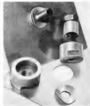
In 1 1/2 Min. werden mit dem Rekordlocher einwandfreie Löcher in Metall und alle Materialien gestanzt. Leichte Handhabung - nur mit gewöhnlichem Schraubenschlüssel. Standardgrößen von 10-61 mm Ø, ab 9.10 DM
