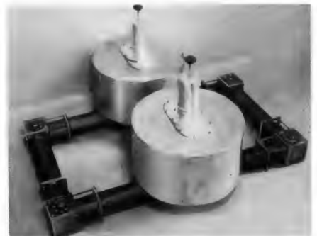
Bild 3. Bild-Ton-Weiche eines 10-kW-UHF-Fernsehsenders (Telefunken)
