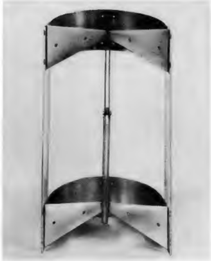
Bild 1. Aufbau der Telefunken-UHF-Zimmerantenne. Zwei Breitband-Dipole sind über eine Transformationsleitung miteinander verbunden; jeder Dipol befindet sich vor einem halbkreisförmigen Reflektor
