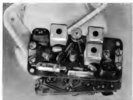
Kleiner Antennenverstärker mit Mesa-Transistor für einen Kanal in Bereich III, mit Zener-Diode zur Stabilisierung der Speisespannung. Messwerte nach Herstellerangaben:
