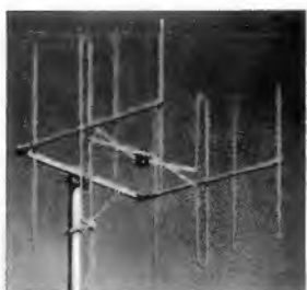
Bild 10. Zwei Vertikalantennen im Abstand von 1/2 zur Reflexionsunterdrückung (Modell Fesa V 2-4 D von Hirschmann)
