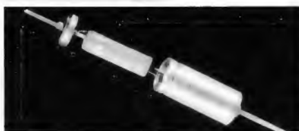
Bild 9. Bestandteile eines Tantal-Kondensators mit Sinter-Elektrode von der Standard Elektrik Lorenz
