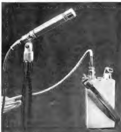
Der früher recht schwerfällige Batteriekasten zum Betrieb eines Kondensatormikrofons ist auf Postkartengröße komprimiert (AKG, München)
