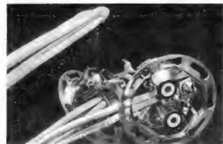
Neuartige Doppelsteckdose für Gemeinschaftsantennen-Anlagen mit Kabel-Schnellklemmung. Das zur Dose hin- und von ihr wegführende Kabel wird mit einer neuartigen Klemme festgehalten und kontaktiert, ohne daß man es abisolieren muß; lediglich das Abschirmgeflecht ist wegzuschieben (Kathrein, Rosenheim/Obb.)
