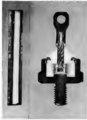
Bild 7. Querschnitt eines diffundierten 10-A-Siliziumgleichrichters der Standard Elektrik Lorenz. In dem seitlich angefügten vergrößerten Schnitt durch das Siliziumplättchen ist der mit der Diffusionstechnik erzielbare sehr ebene Übergang zu erkennen
