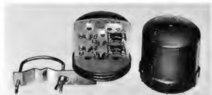
Bild 20. Antennenweiche 402/IV zum Zusammenschalten einer UHF- und einer VHF-Antenne auf eine gemeinsame Niederführung (Wisi)
