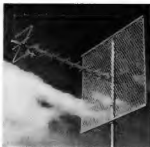
Links: Bild 11. Bereich-V-Antenne vom Typ Backfire für eine Kanalgruppe, mit 16 dB Gewinn (Kathrein)
