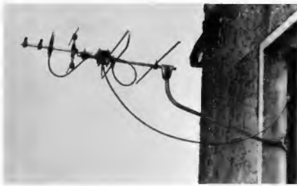
Bild 5. Universal-Fensterantenne FSA 3 U 7. Das UHF-Teil läßt sich um rund 180° in der Horizontalen schwenken (Fuba)
