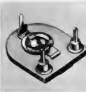
Bild 3a. Nur 15 \text{ mm} breit sind die Trimpotentiometer mit keramischem Schichtträger von Dralowid, dabei sind sie bis zu 0,5 \text{ Watt} belastbar
