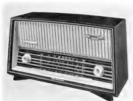
Bild 11. Volltransistorisierter Exportempfänger mit drei Kurzwellenbereichen und Mittelwelle (Schaub-Lorenz Adria TE 203)
