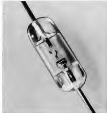
Bild 1. Siemens-Germanium-Spitzdiode in Glasausführung, noch nicht lackiert. Man erkennt deutlich den Aufbau des klassischen Kristalldetektors
