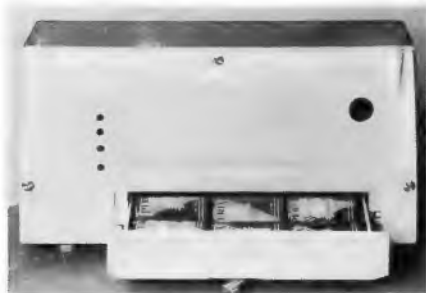
Bild 10. Batteriekasten in einer Grundig Transonette; er ist gegen ein Netzteil auswechselbar
