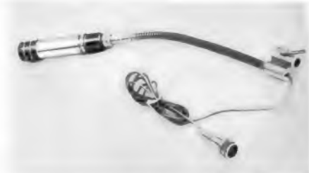
Bild 15. Peiker-Mikrofon PM 3 auf dem selbstgefertigten Schwannenhals
