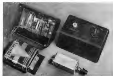
Fortschrittliche KW-Amateure können ihre Stationseiche mit einem dieser kleinen transistorbestückten Quarz-Eichpunktgeber überwachen. Der obere arbeitet vollkommen selbständig mit eingebauter Batterie, der untere wird in den Empfänger eingebaut (Max Funke KG, Adenau/Eifel)
