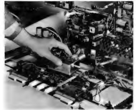
Bild 4. Einsetzen des UHF-Tuners in ein neues Fernsehempfänger-Chassis von Grundig. Diskus-Kanalschalter und UHF-Tuner sind an verschiedenen Plätzen untergebracht
