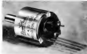
Bild 2. Drahtpotentiometer Typ P 4 von Rosenthal mit Anschlußdrähten für gedruckte Schaltungen
