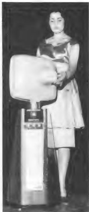
Links: Bild 3. Eigenwillig geformter Fernsehempfänger mit aufgesetzter drehbarer Bildröhre (48 cm) vom Typ bonded shield, Modell 315 von Atlantic Electric
