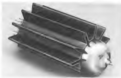
Bild 9. Wie die Kühlrippen eines Motorzylinders umgibt der Kühlkörper die Röhre. Die Kühlung erfolgt durch bessere Wärmeabstrahlung und zusätzlich durch Kaminwirkung der Hohlrippen
