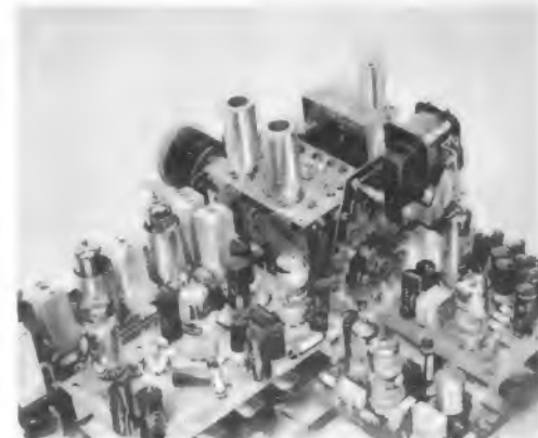
Bild 2. Teilchassis des in Bild 1 gezeigten Voxson-Fernsehempfängers. Man erkennt den VHF-Kanalschalter, rechts oben den UHF-Tuner (mit nur einer Röhre) und die Schaltscheibe mit Antriebsmotor
