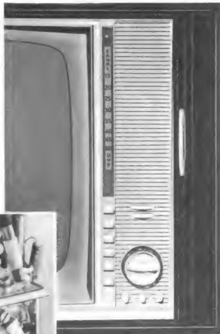
Bild 1. Bedienungsfeld rechts neben der Bildröhre am Telefonken-Fernsehempfänger FE 251 T mit UHF-Schwungradantrieb, UHF-Linearskala und dahinter untergebrachtem Diskantlautsprecher
