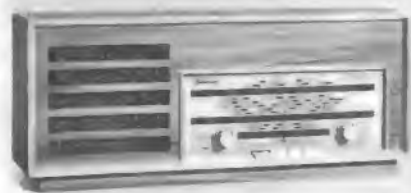
Bild 5. „Schnurloser“ Volltransistor-Heimempfänger Modell Transiton von Centrum Radio (9 Transistoren, 5 Dioden, Lang-, Mittel- und Ultrakurzwellen, Ferritantenne, UKW-Gehäuse-dipol, Sprechleistung 1,5 W, Gewicht 2,75 kg mit Batterie, Abmessungen 400 x 170 x 110 mm)
