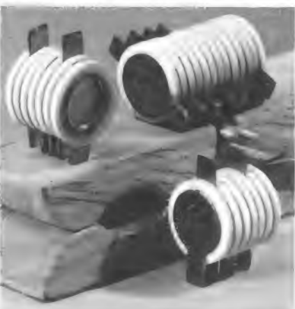
Bild 7. Keramische TIMMS-Moduln der General Electric Co. auf einer Wäscheklammer zum Größenvergleich
