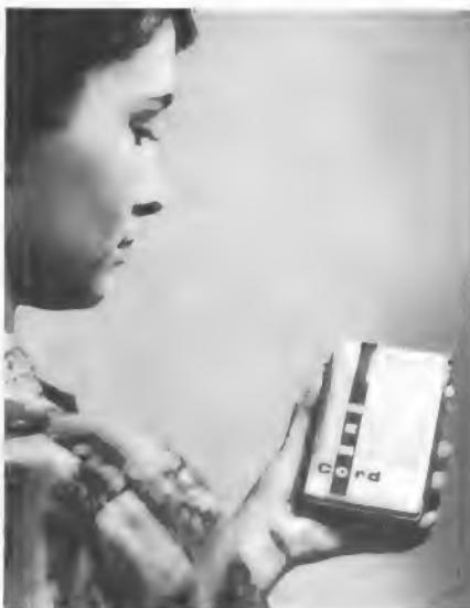
Bild 3. Das „sprechende Notizbuch“ Memocord, ein batteriegespeistes Volltransistor-Tonbandgerät, nur 116 x 80 x 38 mm groß und 350 g schwer. Aufnahmezeit eine Stunde, Mikrofon und Kleinstlautsprecher eingebaut, dazu Vor- und Rücklauttaste und Bandlängenzählwerk. Batteriesatz für 12 Stunden ausreichend. Schon wegen seines Preises (985 öS) war das Gerät eine gewisse Sensation auf der diesjährigen Wiener Frühjahrmesse
