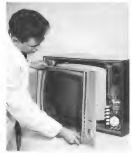
Bild 3. Die gesamte Frontabdeckung einschließlich Schutzscheibe läßt sich bei diesem Telefonken-Fernsehempfänger FE 251 T abnehmen
