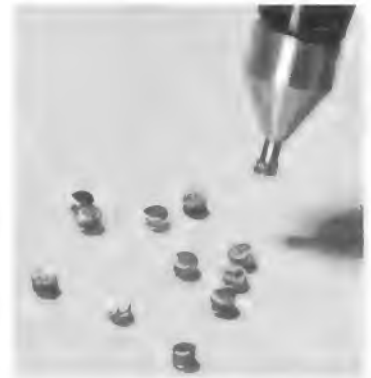
Bild 11. Punktförmige Dioden und Transistoren mit speziellem Aufnahme-Werkzeug. Jedes Plättchen ist bei 1,2 mm Durchmesser 0,8 mm hoch (Hughes Aircraft Co.)
