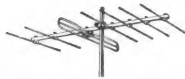
Antenne Grenzland zum Empfang von K 5 und K 9 aus entgegengesetzter Richtung
