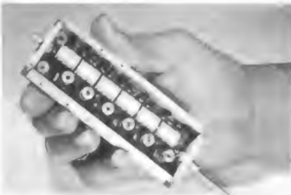
Bild 6. Sechsstufiger 60-MHz-Zf-Verstärker mit keramischen Trioden Typ 7462 der General Electric Co.
