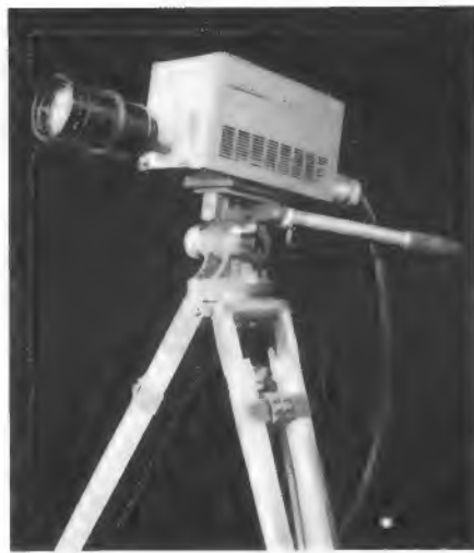
Bild 2. Volltransistorisierte Fernsehkamera für industrielles Fernsehen von Nippon Electric Company
