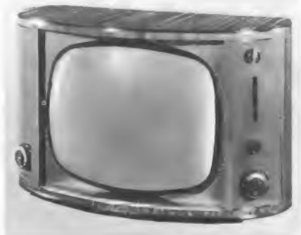
Bild 4. Ein typisches englisches Fernsehgerät mit 43-cm-Bildröhre und eingebautem UKW-Teil (G.E.C., Modell BT 322)
