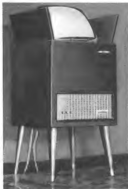
Links: Bild 3. Eigenwillig geformter Fernsehempfänger mit aufgesetzter drehbarer Bildröhre (48 cm) vom Typ bonded shield, Modell 315 von Atlantic Electric
