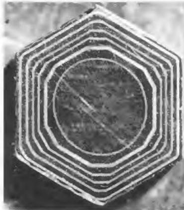
Bild 9. Querschnitt eines Silizium-Kristalls, auf dem abwechselnd zwölf verschiedene Schichten von p- und n-Silizium aufgetragen sind (Merck & Co.)
