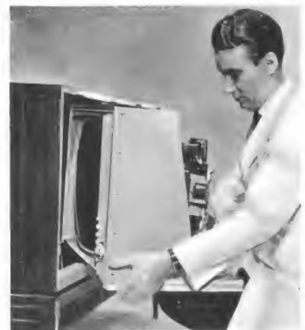
Bild 12. Der Fernsehteil der Kombination Telefunken-Terzola VI läßt sich als stabile Einheit aus der Truhe herausnehmen - einschließlich Bildröhre und Frontabdeckung
