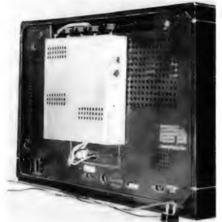
Bild 1. Der Stereo-Zusatzverstärker an der Rückwand des Rundfunkempfängers
