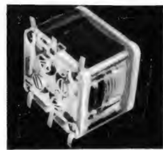
Ein Miniatur-Vierfach-Drehkondensator für AM/FM-Empfänger von Mitsumi
