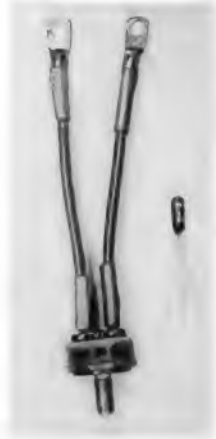
Bild 1. Ein AEG-Leistungstransistor OD 650 im Größenvergleich zu einem Telefunken-Endstufentransistor OC 604 für kleine Leistungen; der Kollektorschlußbolzen des OD 650 mit dem Gewinde M 8 ist dicker als der gesamte Transistor OC 604
