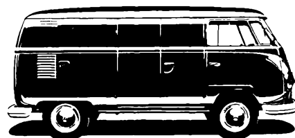
VW-Kastenwagen: 4,8 cbm Laderaum; 830 kg Nutzlast; große Zweiflügel-Tür an der Gehsteigseite.
