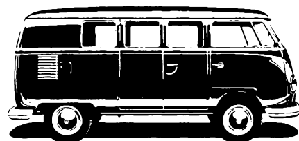
VW-Kombi: 4 cbm Laderaum; 810 kg Nutzlast; Sitzeinrichtung für 7 oder 8 Personen.
