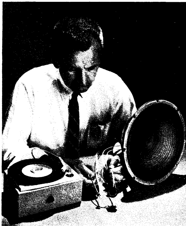
Bild 2. In der Mitte zwischen Plattenspieler und Lautsprecher zwei Funktionsblöcke, und zwar ein Nf-Vorverstärker und ein 5-W-Endverstärker mit Wärmeableitung; obere Frequenzgrenze ist 20 kHz
