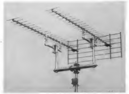
Bild 5. Zwei 23-Element-Antennen DFA 1221 auf einem Parallel-Antennenträger mit Reflektorwand und Anschlußkasten zur Verbesserung des V/R-Verhältnisses
