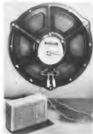
Bild 1. Transistor-Gegentaktendstufe als Zusatzverstärker zum Portable
