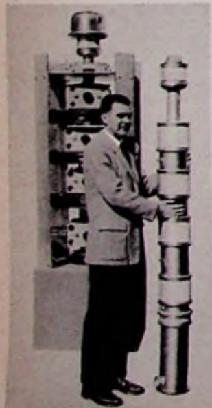
Bild 6. 75-kW-Vierkammerklystron X 602 (Eimac)
