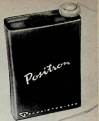
Bild 1. Der Positron-Taschenempfänger von oben mit den Bedienungsrädchen und dem Anschluß für den Kristallhörer
