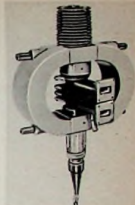
Bild 10. 40-kW-Dreikammerklystron V 24 B (Varian)
