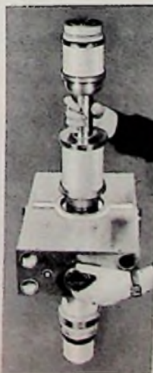
Bild 4b. Dreikammerklystron der Fa. Varian mit organisch eingebautem Topfkreisresonator. (VA 6237-6242-Serie; gesamter Frequenzbereich von 6 Klystrons: 70...890 MHz, N_a = 15 kW; Leistungsgewinn = 40 dB; Wirkungsgrad 40 %; Beschleunigungsspannung 17 kV)
