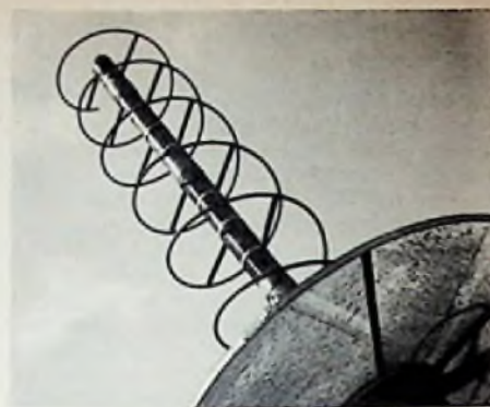
Wendelantenne für 100...160 MHz (vgl. FUNKSCHAU 1958, Heft 15, Seite 363)
