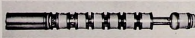
Bild 7. 10-kW-Sechskammerklystron X 631 (Eimac)
