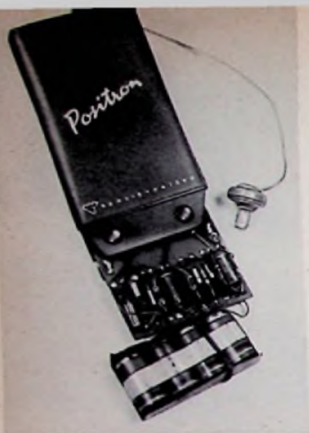
Bild 4. Der Taschenempfänger von unten mit herausgezogener Montageplatte und Batteriekombination
