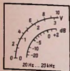
Bild 16. Die Skala des Mustergeräts (vereinfacht); Richtlinien für die Teilungen siehe Tabelle 2
