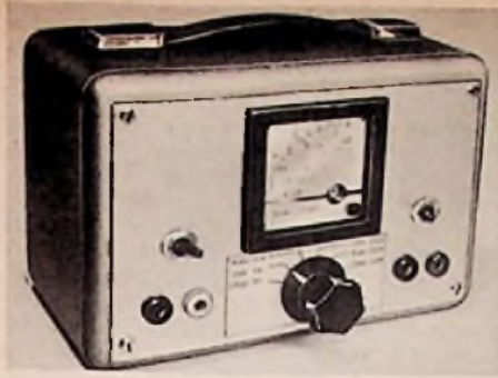
Bild 1. Das betriebsfertige Nf-Transistorvoltmeter
