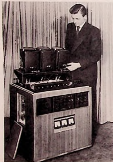
Bild 1. Dreifarben-Projektor Marconi BD 876. Die drei Einheiten mit einer Schmidt-Optik sind hochgeklappt; in Arbeitsstellung zeigen sie nach vorn zur Projektions-Leinwand
