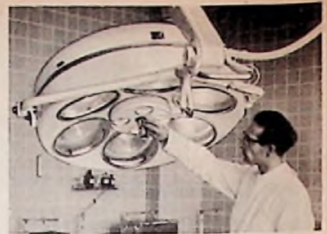
Bild 3. Im Zentrum der Operationsleuchte befindet sich das Objektiv der kleinen Vidikon-Fernsehkamera
