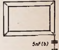
Bild 6. Kapazitiv-Erdung der metallisierten Bildmaske
