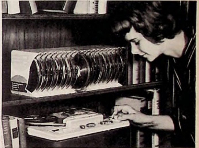
Bei den neuen Kassetten für das Telefunken-Doppelspielband DS 65/DS 75 ist der durchsichtige Innenteil leicht herauszuschwenken
