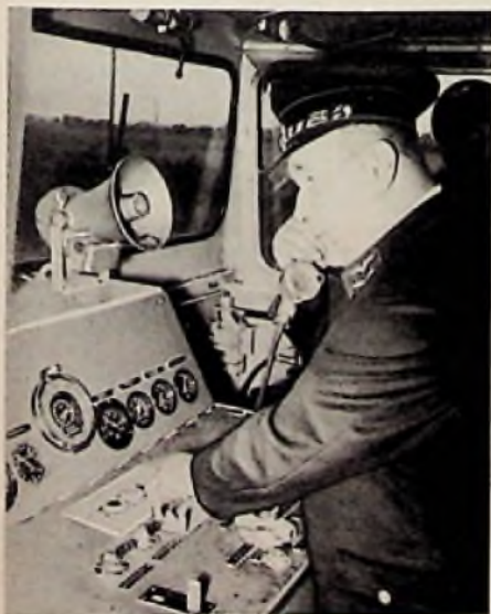
UKW-Telefon-Bediengerät und Lautsprecher von BBC im Führerstand einer Lokomotive. Sämtliche Teile sind explosionsgeschützt
