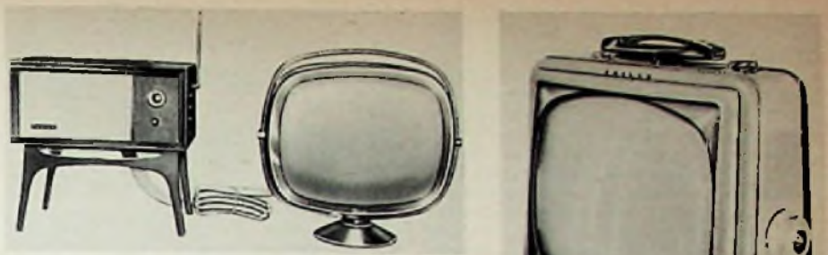
Bild 5. „Predicta Tandem“ mit abgesetzt aufstellbarer Bildröhre, sonst entsprechend dem Modell „Predicta 4242“
