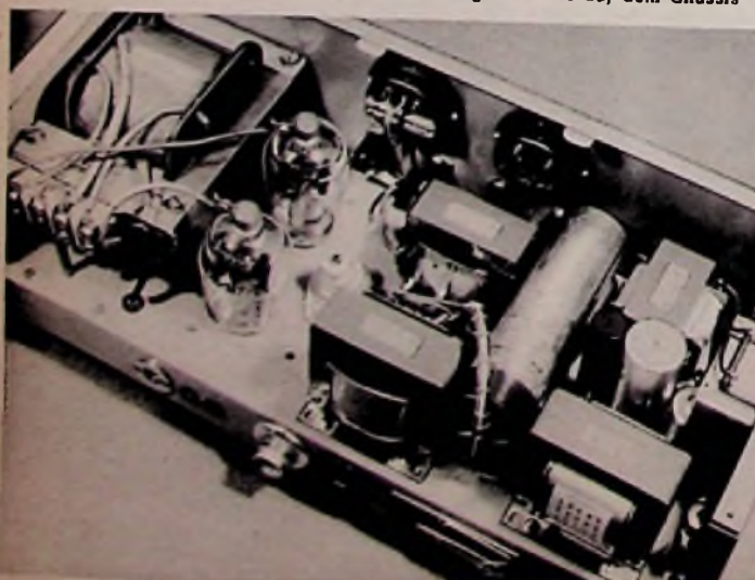
Bild 15. Aufsicht auf das Netzteil-Chassis
