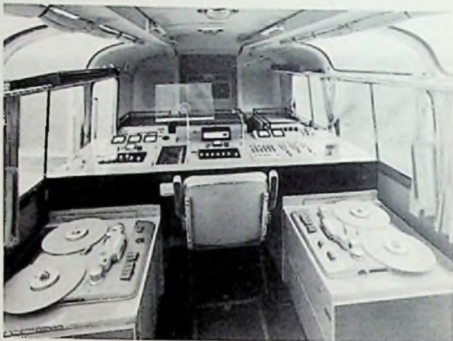
Blick in den neuen Übertragungswagen des Bayerischen Rundfunks, Typ „Nürnberg“, mit den beiden Studio-Magnetophonen im Vordergrund und dem Doppelmischpult dahinter
