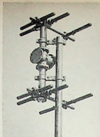
Bild 4. Eine der drei Ballempfangsantennen (im Bild: die verstellbare, witterungsfeste Ausführung für Band III)
