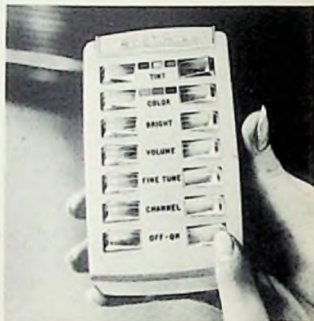
Fernsteuergerät für Farbfernsehempfänger mit transistorisiertem Ultraschallsender
