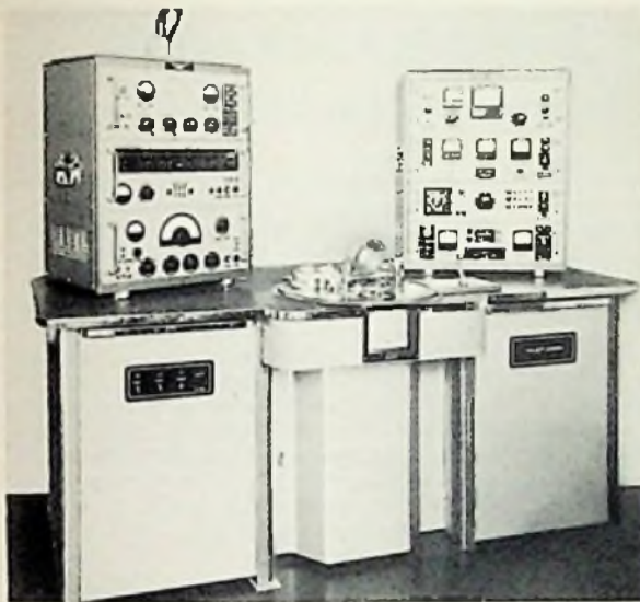
Bild 8. Gesamtansicht der in Bild 7 skizzierten Aufdampfanlage. In der Mitte Drehtisch mit drei Rezipienten, links Präzisionsfrequenzmesser 1 kHz...300 MHz, Genauigkeit 1 \cdot 10^{-2} , rechts Automatik, im Tisch Vakuumpumpen und Stromversorgung
