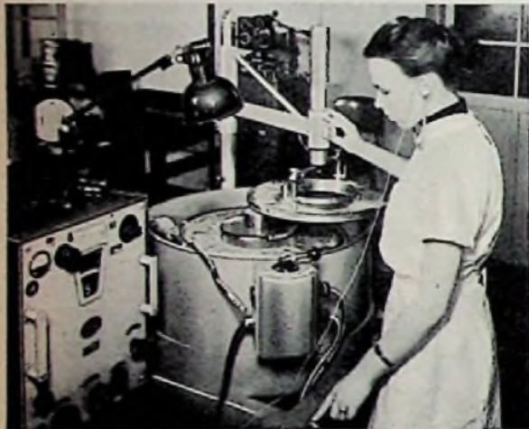
Bild 3. Lappmaschine [geöffnet] mit angeschlossenem Empfänger für die Frequenzüberwachung in der Quarzfertigung der C. Lorenz AG
