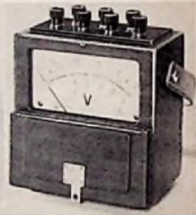
Bild 2. Tragbares Drehspulinstrument mit 1 MΩ/V im Edelmetallgehäuse (Siemens & Halske)
