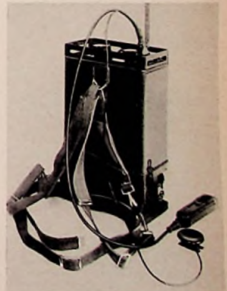
Bild 2. 100-Kanal-Tornisterfunktisprechanlage für das 4-m-Band (Standard Elektrik Lorenz AG)
