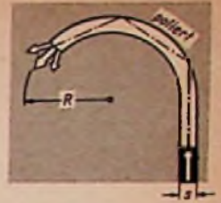
Bild 2. Damit im Bogenstück kein Licht austritt, darf dort das Licht nirgends steiler als unter 42° auf die Wand auftreffen
