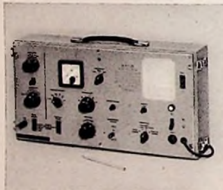
Bild 7. Kontaktfehlersuchgerät Rel 3 K 53 von Siemens & Halske zum Aufspüren schlechter Löt- und Kontaktstellen in Nachrichtensystemen
