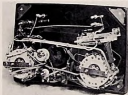
Bild 1. Philips-Universalmeßinstrument P 817 – Innenaussicht. Die Außenansicht erschien bereits in der FUNKSCHAU 1958, Heft 6, S. 147
