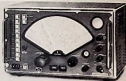
Bild 5. Allwellen-Universalempfänger 745 E 310 mit 11 Bereichen für lückenlosen Empfang zwischen 85 kHz und 30,3 MHz, zugleich 14 bis 21 kHz, mit Frequenzlupe und Eichgenerator, für A 1, A 2 und A 3 (Siemens)
