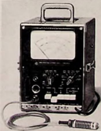
Bild 4. Universal-Röhrenvoltmeter Typ URU von Rohde & Schwarz für die Messung von Gleichspannungen von 5 mV...1000 V, Widerstandsmessung zwischen 0,5 \Omega und 1000 M \Omega , Wechselspannungsmessung 10 Hz...1 MHz von 100 mV...1000 V und HF-Spannungsmessung 1 kHz...1000 MHz von 100 mV...100 V
