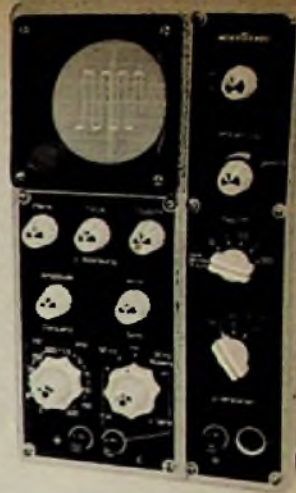
Bild 1. Nordmende-Universal-Oszillograf UO 963. Auf dem Bildschirm das Kontrollsignal
