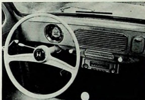
Bild 2. Im Auto wird der Empfänger Trifels einfach in eine Halterung unter dem Armaturenbrett eingeschoben
