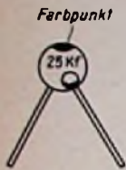
Bild 1. Beispiel für die Kennzeichnung eines Scheibenkondensators
