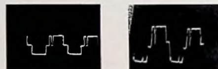
Bild 6. Kurven eines Zershackers, den man gerade noch als „gut“ bezeichnen kann
