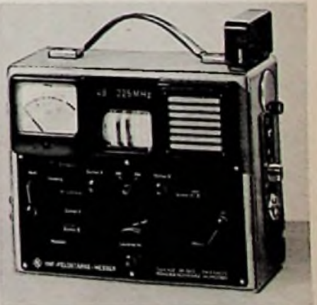
Bild 1. Ansicht des Feldstärkezeigers HUZ der Firma Rohde & Schwarz. Links von der Trommelskala das Anzeige-Instrument, rechts der Kontroll-Lautsprecher
