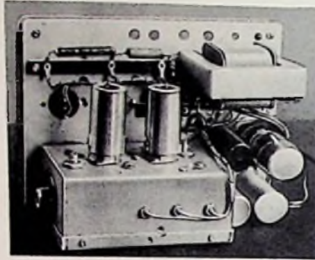
Bild 4. Zusammenbau des 2-m-Converters mit einem kleinen Netzteil
