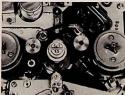
Bild 3. Ansicht des Umschaltmechanismus. In der Mitte dor gerade auf 9,5 cm/sec stehende Umschaltknopf
