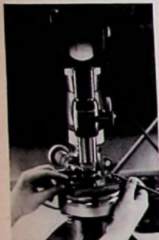
Meßmikroskop mit übersichtlicher Anzeige zum Messen der Dicke von Germaniumplättchen
