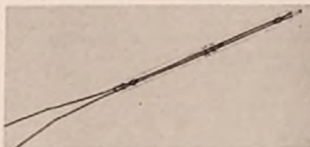
Bild 2. Der Thernowid-Heißleiter-Temperaturfühler K 16 dient zur fast trägheitslosen Temperaturmessung bis zu 200° C. Er kann auch als Temperatur-Sonde im lebenden Körper verwendet werden (Siemens)
