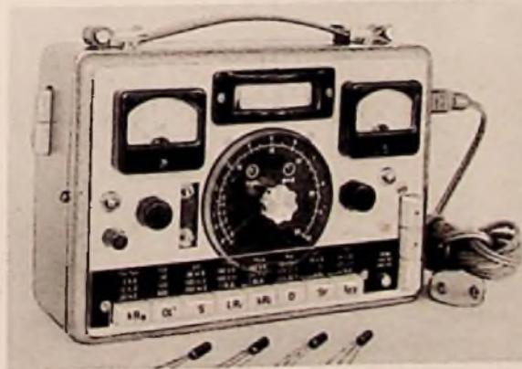
Das Transistor-Meßgerät Teletrans I von Telefunken. Es dient zur exakten Arbeitspunkteinstellung und zum Ausmessen von insges. 13 statischen und dynamischen Transistor-Kenngrößen
