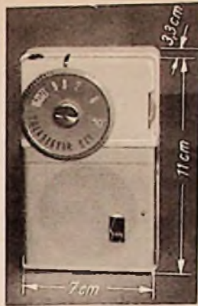
Bild 1. Taschensuper Sony mit sechs Transistoren
