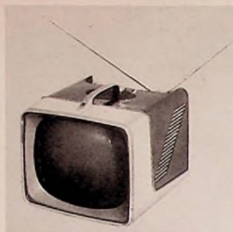
Das erste deutsche, von Grundig gebaute tragbare Fernsehgerät mit 36-cm-Bildröhre
