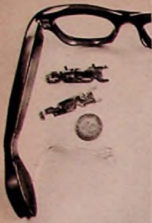
Bild 4. Teilbild der Siemens-Reiniger-Rodonstock-Hörbrille für stereophonisches Hören. Daneben die geätzte Schaltung und ein fertiger 3stufiger Transistorverstärker
