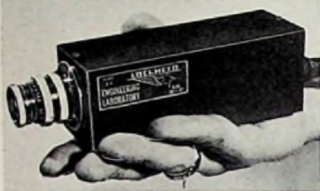
127 mm lang ist diese Fernsehkamera der Lockheed-Aircraft Corp. für den Einsatz bei Testflügen neuer Maschinen
