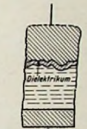
Bild 2. Bei einem Elektrolytkondensator mit aufgerauhter Anode ist die wirksame Oberfläche größer
