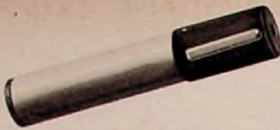
Bild 4. Der Multitone-Empfänger mit Clip wiegt einschließlich Batterie 140 Gramm und ist bei 25 mm Durchmesser 137 mm lang
