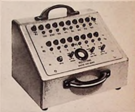
Bild 5. Codierungs- und Besprechungsgerät für den Multitone-Vorverstärker mit eingebautem Kristallmikrofon und Zahlentaster
