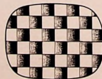
Bild 1. Beim Schachbrettmuster wurden die schwarzen Felder nach rechts zunehmend dunkler
