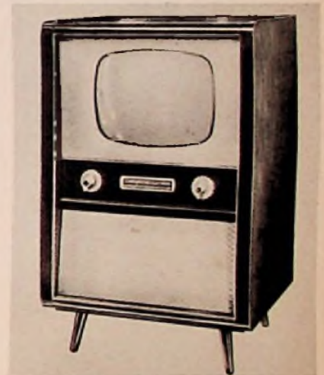
Bild 3. Fernseh-Standgerät mit UKW-Teil, Modell „Forum“ FE 855 K. Der UKW-Teil besitzt eigene Skala, 11 Kreise und eine gemessene Empfindlichkeit von 3 \mu V bei 26 dB Rauschabstand
