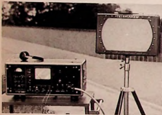
Bild 1. Telefunken-Verkehrsradar, betriebsfertig aufgebaut. Mit dem Kopfhörer läßt sich die Dopplerfrequenz akustisch überhören
