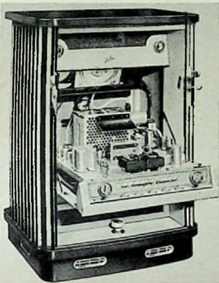
Bild 10. Nach Entfernen der Deckplatte kann das Empfängerschassis ausgeschwenkt werden, so daß alle Teile frei zugänglich sind. Der große Knopf unten Mitte dient zur Arretierung des Empfängers gegen Verschieben auf dem Fußboden
