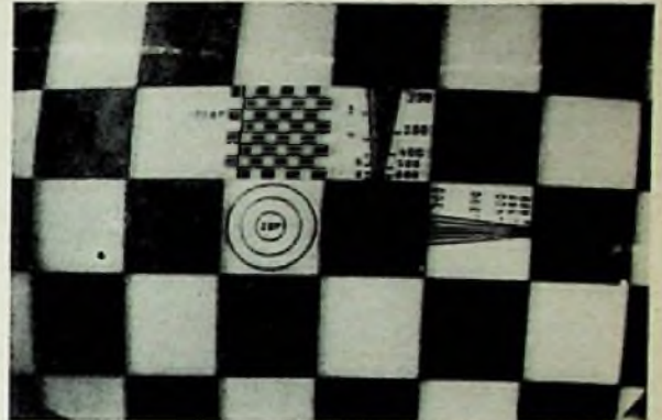
Bild 7b. Erhebliche Fehlanpassung ( m_A \approx 5; m_E = 2 )
