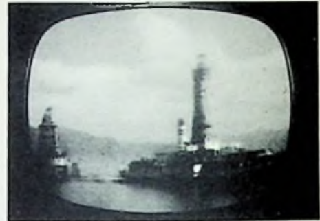
Bild 7. Oszillator nach unten verstimm. Hohe Frequenzen fehlen, Bild ist unscharf
