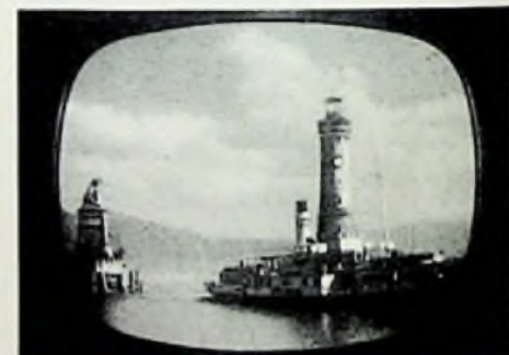
Bild 9. Einwandfrei abgestimmtes Bild nach Loslassen der Abstimm-taste
