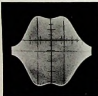
Bild 2. Durchlaßkurve des Tuners bei korrektem Abgleich und genau angepaßter Antenne
