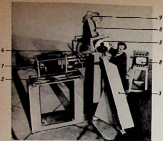
Bild 3. Das Fernsteleskop von Süden. 1 = Fernsehkamera, 2 = Kameraragen zur Scharfeinstellung. 3 = Spiegelteleskop, 4 = Zwischenoptik zur Vergrößerung des Brennpunktbildes, 5 = Planspiegel, 6 = Stundenachse, 7 = Antriebsrichtung, 8 = Kontrollschirm
