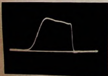
Bild 3. Durchlaßkurve von Tuner (Kanal 7) und Zwischenfrequenzverstärker (maximal zulässige Abweichung von der Normkurve)
