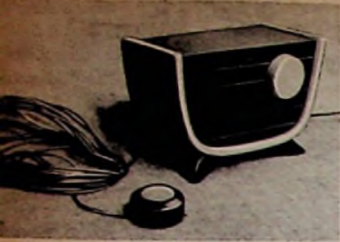
Bild 1. Mit Hilfe dieses kleinen, geschmackvollen Übertragungsgerätes lassen sich spielende oder schlafende Kinder von einem andern Zimmer aus überwachen
