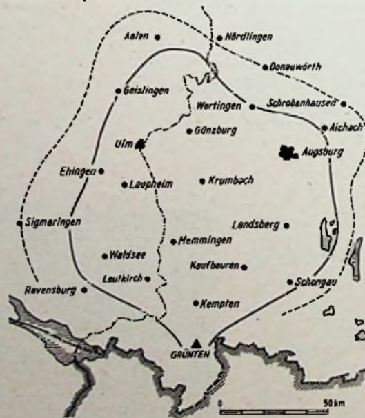
Bild 2. Reichweite des Fernsehsenders Grünten. Die bisher mit dem UKW-Sender gemachten Erfahrungen lassen das durch die ausgezogene Linie begrenzte Versorgungsgebiet erwarten. In der Zone zwischen der ausgezogenen und der gestrichelten Linie kann man vielfach bei höherem Antennenaufwand ebenfalls zufriedenstellenden Empfang erwarten.
