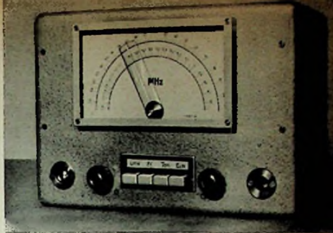
Bild 1. UKW-Prüfsender M 567 mit großer übersichtlicher Skala und Drucktasten-Bedienung
