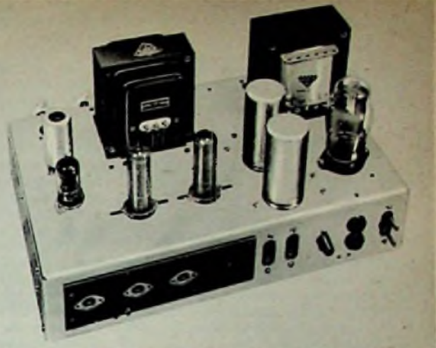
Bild 6. Ansicht des Chassis von der Anschlußseite. Die abgeschirmten Eingangsbuchsen sitzen auf einer gemeinsamen Isolierplatte
