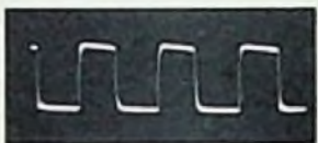
Bild 9. Eine mit dem Transistor-Multivibrator erzeugte Rechteckschwingung
