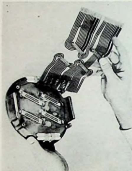
Eine als biegsames Kabel ausgebildete gedruckte Schaltung mit Steck-Verbindungen
