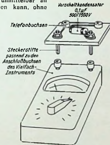
Eine praktische Ausführungsform für das Aufsteckbrotchen mit dem Vorschaltkondensator
