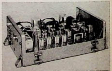
Bild 6. Fahrzeug-Funksprechanlage mit Subminiatur-Röhren (Tekode B 70)
