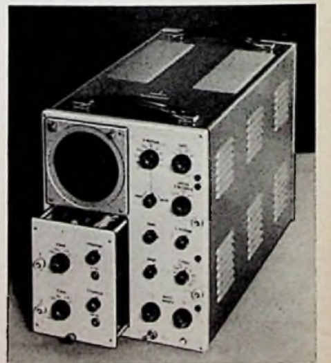
Bild 3. Zwei-Strahl-Oszillograf Oscillar II von Siemens & Halske mit auswechselbarem Y-Verstärker
