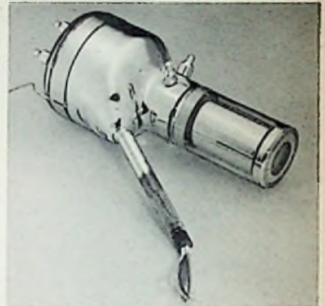
Bild 2. Die neue Fernseh-Bildaufnahmeröhre Szenioskop, die äußerlich dem Zwischenbild-Ikonoskop entspricht
