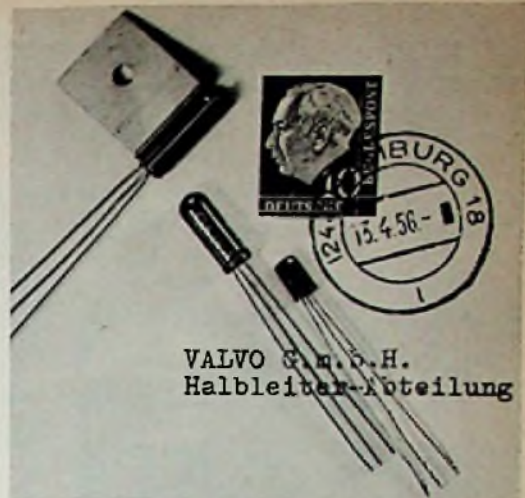
Bild 7. Valvo-Transistoren im Vergleich zu einer Briefmarke; links oben Flächentransistor OC 72 mit Kältschelle, darunter OC 71, daneben Miniatur-Transistor OC 65
