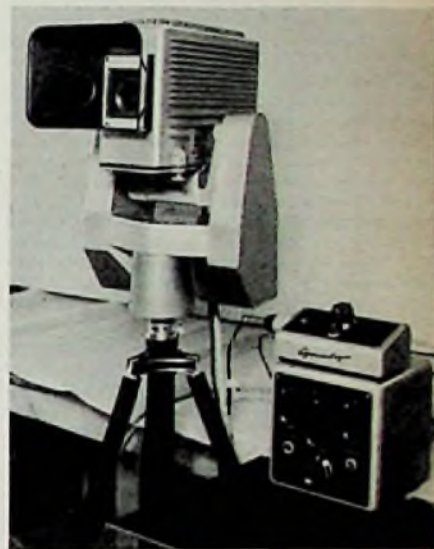
Bild 9. Grundig-Fernnahe mit Schwenkkopf und Geräten für Fernbedienung aller Kamerafunktionen
