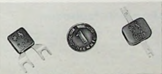
Bild 3. Zwei kunststoffgepreßte Ausführungen des Siemens-Gehörschutzgleichrichters für Kopfhörer
