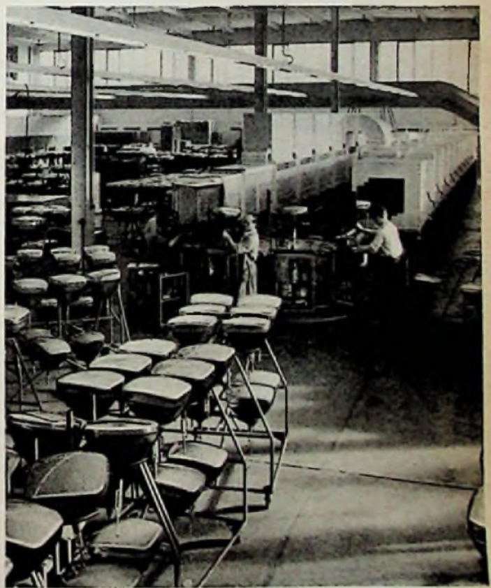
Bild 3. Blick auf die Ovalbahn der Pumpeneinheiten für Bildröhren. Jeder Röhre ist ein als Wagen konstruierter Pumpstand zugeordnet. Sie durchlaufen (im Bild rechts) einen Tunnelofen mit verschiedenen Heizzonen und hochfrequenten Glüheinrichtungen, um das erforderliche Vakuum zu erzielen
