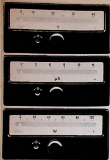
Bild 8. Drei übereinander angeordnete Betriebsinstrumente mit Lichtmarkenanzeige für Prüfplätze von Siemens & Halske
