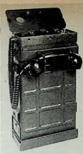
Links: Bild 7. 15-Watt-Funksprechgerät FuG 7 von Telefunken für transportablen Einsatz Rechts: Bild 8. Fahrbare Zentrale für ein Funknetz mit FuG 7
