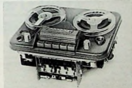
Bild 2. Ferrodyn-Junior, ein neues Bandgerät für eine Bandgeschwindigkeit von 9,5 cm/sec (AWB)
