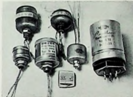
Bild 1. Größenvergleich von hochwertigen Eingangsträgern verschiedener Hersteller mit einem Sahnebonbon. Die Hersteller der Übertrager sind die Firmen Egon Beyer, Heilbronn/Neckar; Helmut Haufe, Usingen/Taunus; Labor W. Bissendorf/Hannover
