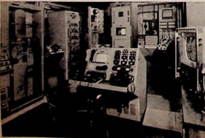
Bild 2. Farbfernseh-Kontrollraum im Alexandra Palace. Links Farbfilmgeber, dahinter Netzstelle und Testbild-Generator. In der Mitte vorn das Kontrollpult mit Dreifarbenbildröhre und Regler für die drei Grundfarben. Ganz rechts ein Kontrollempfänger
