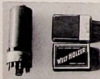
Bild 2. Links Verstärkerblock zum Stecken, oben zum Einlöten (Dr. Rost)
