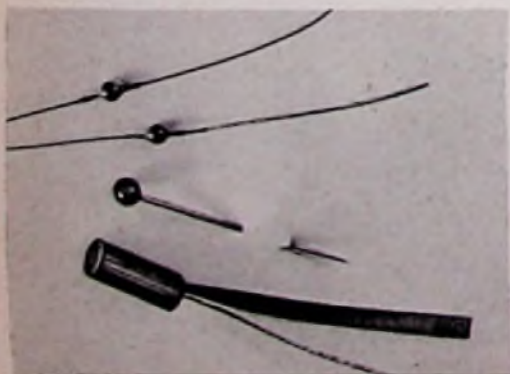
Bild 4. Zwei Subminiaturdioden der Howaldt-Werke im Vergleich zu einem Stecknadelkopf, daneben ein Germanium-Stromleit (Flächendiode)
