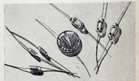
Neukraft - Glimmer - Kleinstkondensatoren: oben rechts in vakuumdichter Glashülle, links die Ausführung ohne Glashülle zum Einbau in gedruckte Schaltungen
