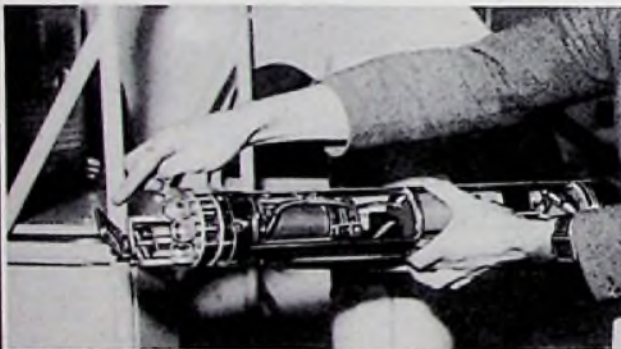
Bild 4. Pye-Spezial-Fernsehkamera für einen Atom-Meiler. Das nahtlose Stahlgehäuse ist entfernt; vorn sind die Beleuchtungslampen und der fernbediente Spiegel für Aufnahmen in allen Richtungen sichtbar
