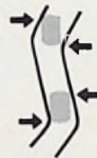
Aus der graphischen Darstellung ist die zerstörende Wirkung der scharfen Kanten eines abgenutzten Saphirs auf die zarten Rillennände ersichtlich
