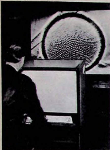
Bild 3. Philips-Fernsehprojektor VE 2600 bei der Übertragung von Mikroskopbildern
