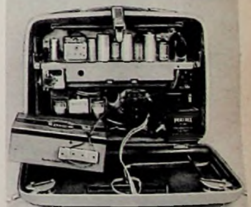
Bild 7. Blick in den Telefunken-„Bajazzo 56“. Deac-Sammler, zwei Monozellen und Pertrix-Heizbatterie Nr. 322 erlauben einen Betrieb von 100 Stunden, die Anodenbatterie übersteht 400 Betriebsstunden
