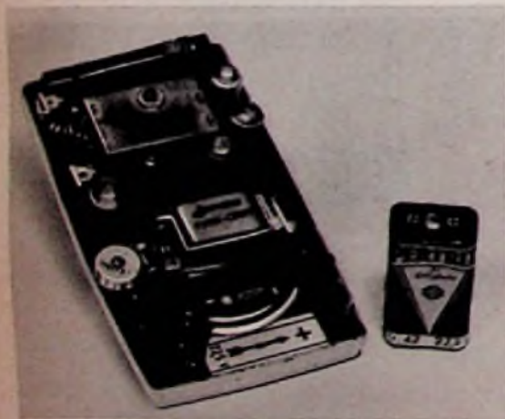
Bild 2. Innenansicht des 6-Transistoren-Taschen-Supers Telefunken TR 1, daneben die 22,5-V-Batterie
