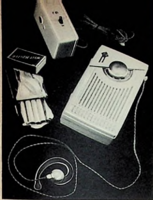
Bild 3. Transistor-Taschen-Super Telefunken TR 1, links oben das Netzgerät
