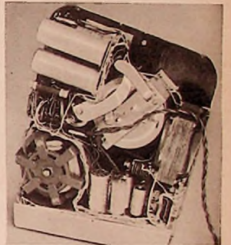
Bild 2. Das Chassis von unten mit Motor, Antrieb, Netztransformator, Lade- und Siebkondensatoren
