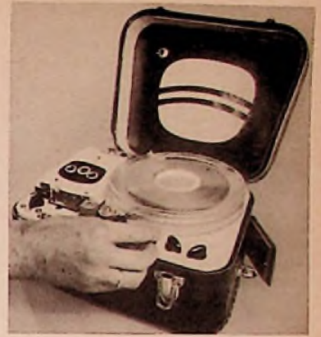
Bild 1. Tonbandgerät mit kleinsten Abmessungen durch übereinander angeordnete Auf- und Abwickelspule
