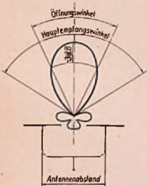
Bild 3. Öffnungs- und Hauptempfangswinkel bei Nebeneinander-Anordnung von Fernseh-Antennen
