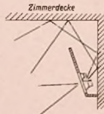
Bild 2. Schematische Darstellung des durch die Schallecke entstehenden, sich nach oben hornartig erweiternden Schallraumes
