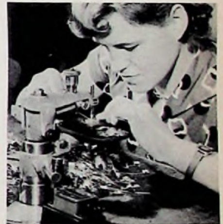
Bild 4. Anschweißen der Anschlußdrähte an die Kontaktfahnen
