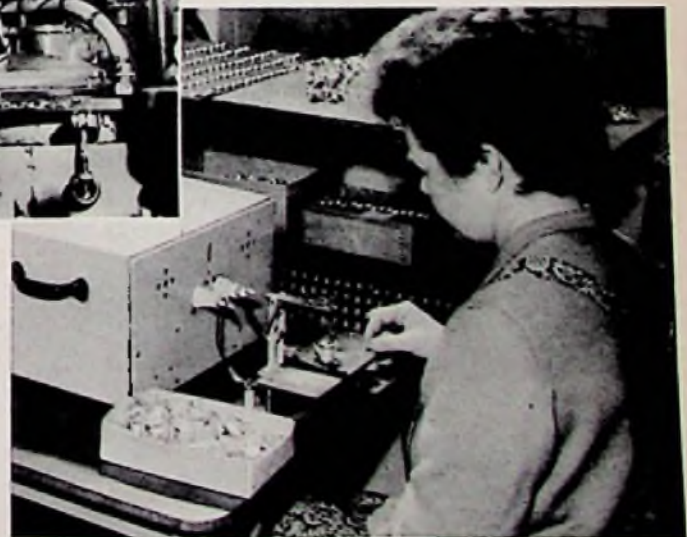
Bild 7. Verlöten dichter Kondensatoren im Hf-Feld
