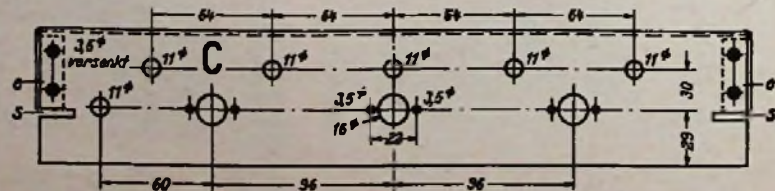
Bild 22. Chassis, Aluminium 2 mm, halbhart, Löcher in D vom Rahmen abbohren
