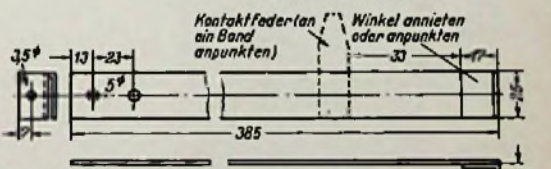
Bild 28. Spannband für die Bildröhre. (2 Stück, Eisenblech 1 mm; Verstärkungswinkel 1,5 mm. Band mit 3-mm-Schaumgummi auslegen)
