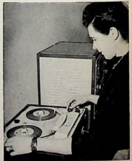
Das Magnetophon einer Telefunken-Schulfunkanlage dient ebenso der Aufbewahrung von Schulfunksendungen für eine passende Unterrichtsstunde, als auch zur unmittelbaren Aufnahme und Wiedergabe von Sprachübungen
