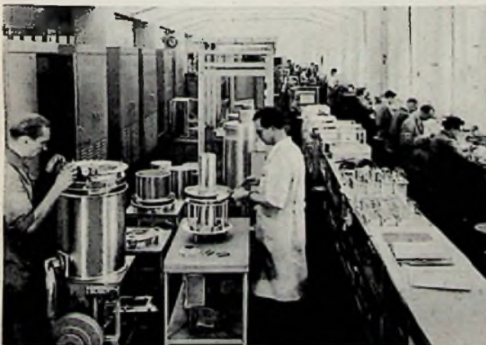
Aus dem Senderbau im Wernerwerk. „Abteilung Gas und Wasser“ wird ein solcher Saal bisweilen scherzhaft wegen der dort gebauten Topfkreise und Hohlrohrleitungen genannt
