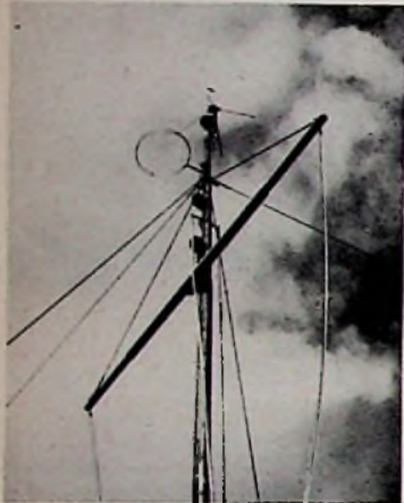
Am Mast der Seeshaupt sind die Antennen für Senden und Empfang angebracht
