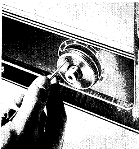
Bild 4. Nachstimmung der Oszillatorschule von vorn ohne Chassisausbau
