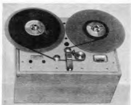
Bild 3. Außenansicht des Tonbandlängen-Meßgerätes. Unterhalb des rechten Bandtellers ist das unmittelbar in Laufzeiten geeichte Zählwerk zu erkennen
