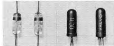
Moderne Valvo-Kristalldioden in Allglastechnik. Die Glaskölbchen der beiden Flächentransistoren sind mit einem lichtundurchlässigen Schutzüberzug versehen
