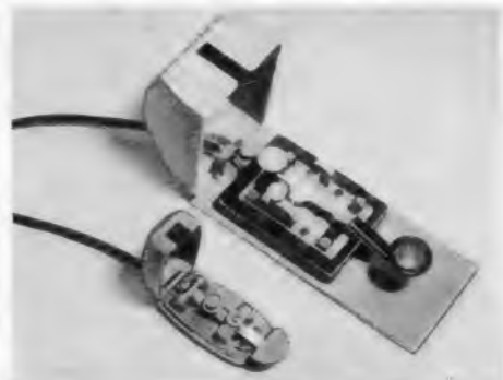
Bild 3. Zwei verschiedene Ausführungsformen von Handtasten (links: Kleinausführung für transportable Verwendung; rechts: massive Stationstaste auf Metallgrundplatte mit Störschutz)
