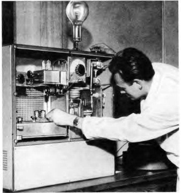
Bild 2. Versuchsaufbau einer automatischen Nachlaufsteuerung im Diathermiegerät
