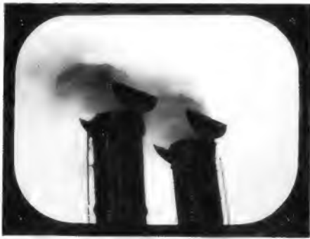
Bild 3. Fernsehbild von Schornsteinmündungen zur Überwachung der Rauchentwicklung
