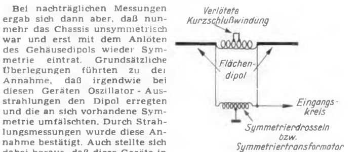
Durch eine Kurzschlußwindung an der Spule eines Flächendipols konnte der Empfang verbessert werden.
