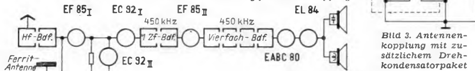
Bild 2. Blockschaltung für KW-, MW- und LW-Empfang
