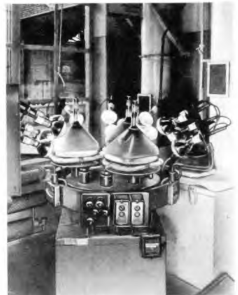
Bild 3. Aus der Bildröhrenfertigung: der äußere, leitende Überzug der Bildröhre wird mit Infrarotstrahlern getrocknet
