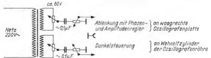
Bild 3. Einfache Netzablenkung für netzsynchronen Wobbler (Masseanschluß der Sekundärwicklungen zur Vereinfachung nicht eingezeichnet)
