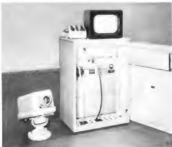
Bild 1. Fernsehanlage für wärmetechnische Betriebsüberwachung. Links der Kamerakopf für die Meßstelle; auf dem Verstärkerschrank das Sichtgerät, das im Beobachtungsraum in die Wand eingebaut werden kann
