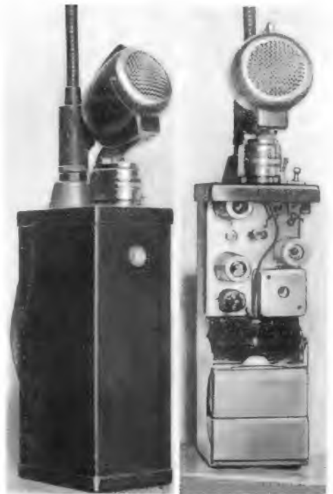
Mikrofon mit batteriebetriebenen Sender für Reportagezwecke.
