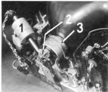
Bild 4. Die Röhre mit umgebogenem Hals in einem Fernsehempfänger. 1 = Fokussierspulen, 2 = Umlenkmagnet, 3 = Ablenkspulen
