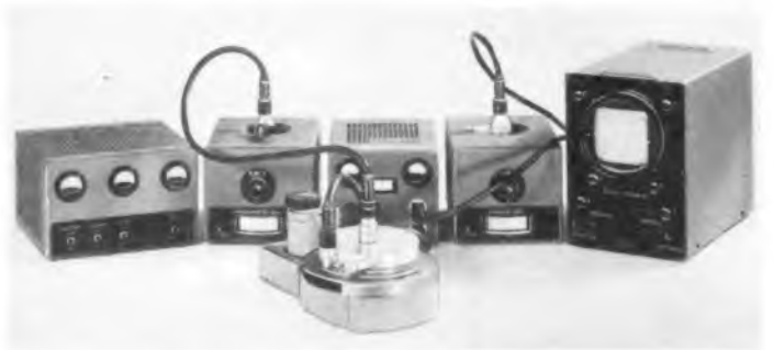
Bild 1. Der Dezimeterwellen-Meßplatz der Firma Elektrische Meßtechnik, Dipl.-Ing. W. Federmann, Stuttgart. Von links nach rechts: Netzgerät, Meßempfänger, Vervielfacher, Meßsender, Sichtgerät. Im Vordergrund die Meßleitung
