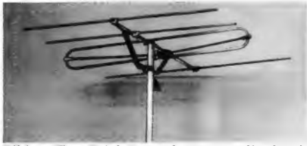
Bild 6. Eine Trial-Fernsehantenne, die durch den keilförmig abgewinkelten, gespeisten Mittelstab leicht zu erkennen ist
