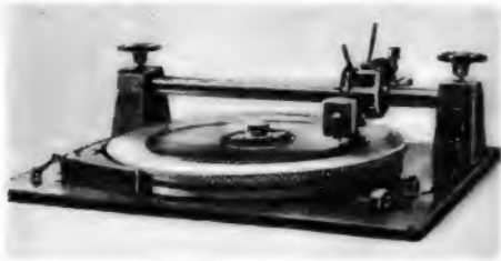
Bild 1. Schallfolien-Aufnahmemaschine für drei Drehzahlen mit einstellbarer Rillensteigung (Saueressig)
