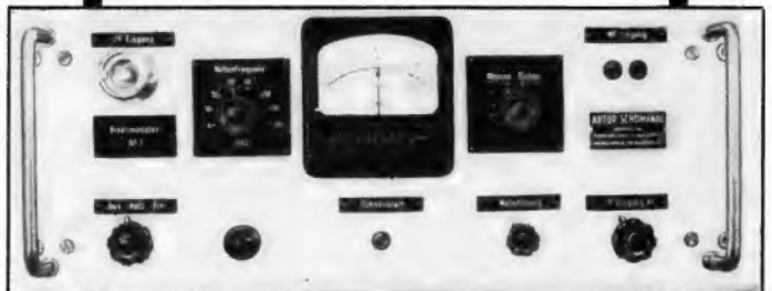
Mittenfrequenzmesser NF 1 zur Messung von FMUKW-Sendern im vollmodulierten Betrieb
