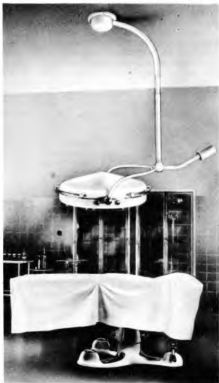
Bild 1. Operationsleuchte mit eingebauter Fernsehkamera in einem Operationssaal
