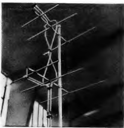
Bild 2. Fuba-Breitband-Antennen mit „Resonanz-Kompensatoren“ (Hans Kolbe & Co)
