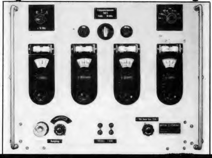
FREQUENZDEKADE ND 5 1 kHz...30 MHz mit verschiedenen Zusatzgeräten
