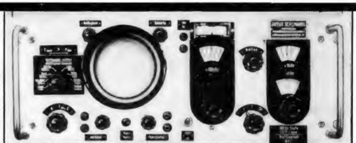
Feindekade NDF 1 zur Erweiterung des Dekadenbereichs auf 100 Hz-Synchronisierungspunkte
