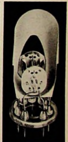
Bild 3. System-Aufbau der EM 85 nach Abnahme der Triodenkappe
