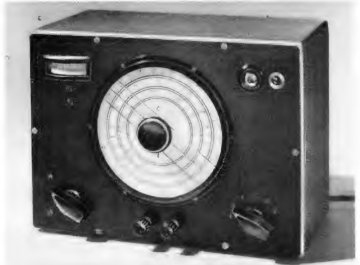
Bild 1. Ansicht des LC-Meßgerätes. Links oben das Anzeigeelement, rechts unten der Bereichsschalter
