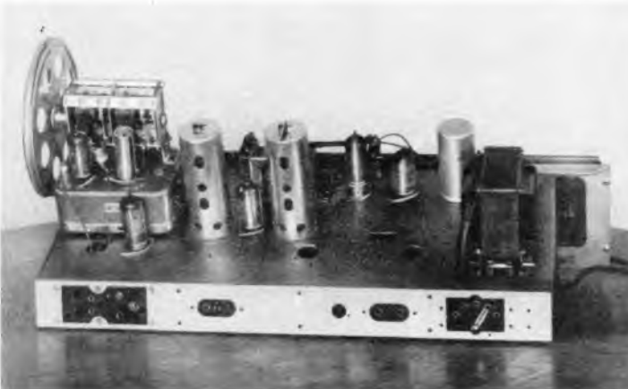
Das breite Chassis des Krefft W 528 ergibt eine übersichtliche Anordnung der Einzelteile. Unter dem Drehkondensator die Abschirmhaube des UKW-Teiles
