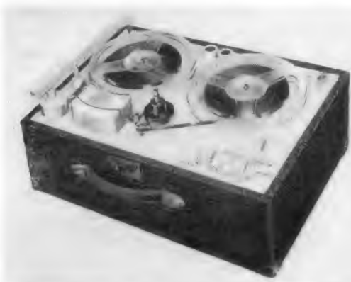
Links: Bild 1. Gesamtansicht des in einen Koffer eingebauten Magnetton-Gerätes Magnafon (Super-Radio, Hamburg)
