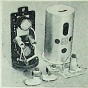
Bild 2. Zf-Kombinationsfilter (468 kHz, 10,7 MHz) und verschiedene Hf-Drosseln
