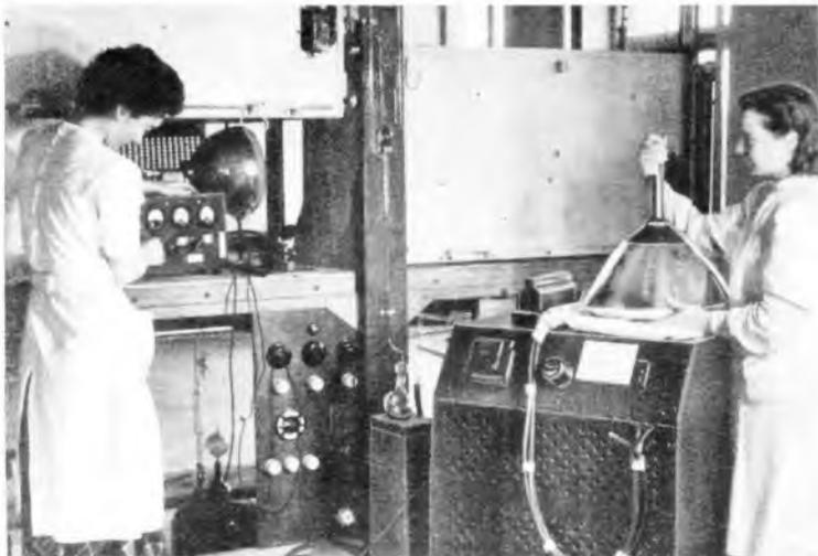
Beim Pumpen der großen Rechteck-Bildröhren. Die Tür eines Pumpschrankes ist geöffnet. Vor der Röhre das Gerät zur Formierung der Kathode, rechts der Glühender, der die Hf-Energie für die Getterung der Bildröhre liefert
