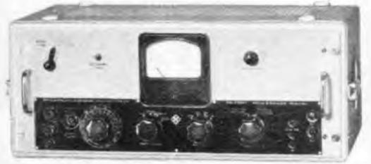
Bild 5. Nutz- und Fremdpegelmeßgerät, Typ UPF (Kombiniertes Klirrfaktor- und Geräuschspannungsmessgerät)
