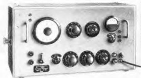
Bild 2. Ansicht der Klirrfaktormessbrücke FTO (50...15 000 Hz)
