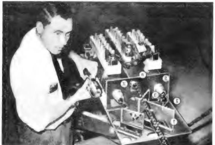
Bild 8. RCA-Farbkamera (Abdeckhaube entfernt). ---= blaue Strahlen passieren den dichromatischen Rotspiegel (1) und werden über den dichromatischen Blauspiegel (3) und Normalspiegel (2) zur Linse (5) reflektiert. ...= grüne Strahlen passieren (1) und (3) und laufen direkt zur Linse (6) ---= rote Strahlen werden durch Rotspiegel (1) und Normalspiegel (4) zur Linse (7) reflektiert. Hinter jeder Linse befindet sich eine Image-Ortkonröhre
