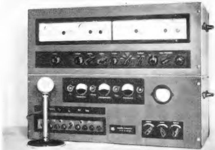
Gesamtansicht des betriebsfertigen Amateur-KW-Senders. Unten befinden sich Netzteil und Oszilloskop, während im oberen Teil der eigentliche Sender untergebracht ist
