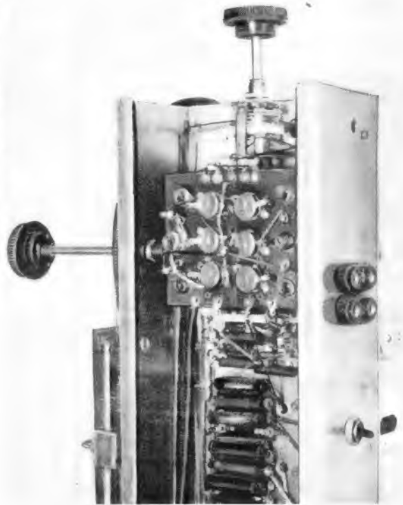
Teilansicht der Verdrahtung mit Spulenaggregat und Wellenschalter
